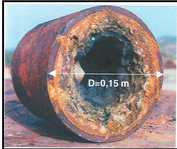
Σχήμα 5.6: Φωτογραφία επικαθίσεων στο αρχικό τμήμα του αγωγού επανεισαγωγής του γεωθερμικού υγρού στη Μήλο (Πηγή: Φυτίκας-Ανδρίτσος, 2004)
