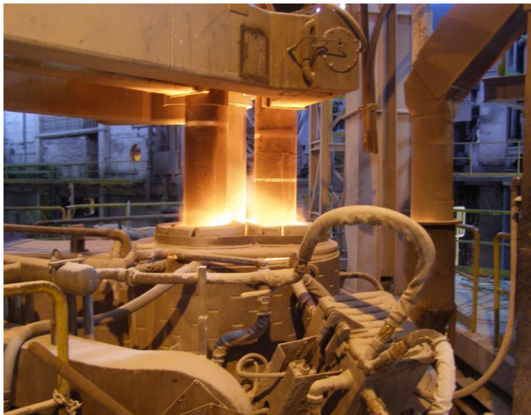
Εικόνα 5.3 Μεταλλουργική διεργασία κατά την οποία καθορίζεται η κραμμάτωση του μείγματος
