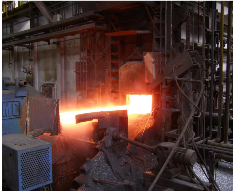
Εικόνα 5.4 Έξοδος της μπιγιέτας από το φούρνο αναθέρμανσης και μέτρηση της θερμοκρασίας T_f από πυρόμετρο σε συγκεκριμένη απόσταση από τον φούρνο
