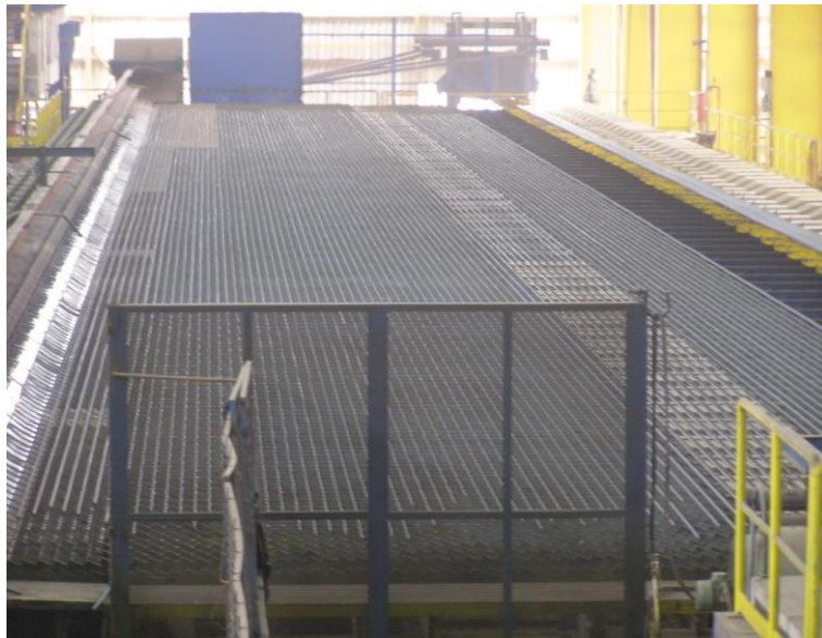
Εικόνα 5.6 Το τραπέζι επαναφοράς, η ράβδος αφήνεται να ψυχθεί στην θερμοκρασία περιβάλλοντος και αποκτά την θερμοκρασία επαναφοράς ομοιόμορφα.
