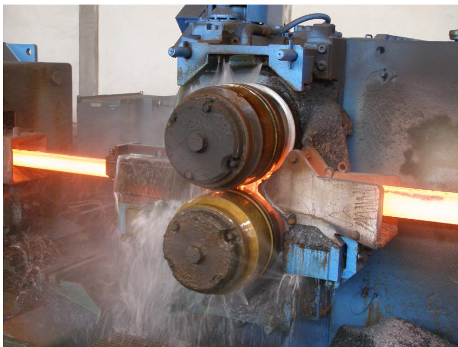
Εικόνα 2.1 Δύο έλαστρα μεγάλης ισχύς αντίστροφα στρεφόμενα τα οποία καταβρέχονται με νερό καθώς η ωστενιτοποιημένη μπιγιέτα περνάει ανάμεσα τους (Χαλυβουργική Α.Ε., Ελασματοουργείο)
