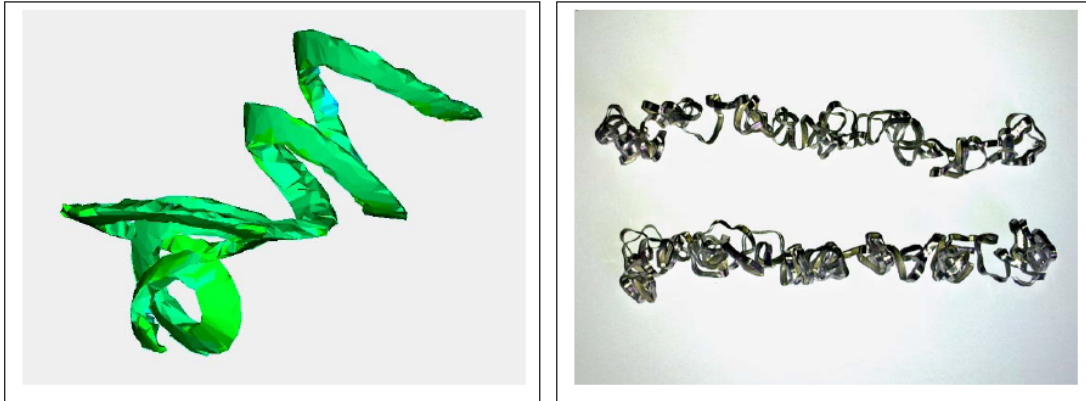
Σχήμα 7.2 Σύγκριση αποβλίτου πειραματικών και αριθμητικών αποτελεσμάτων πρώτου δοκιμίου
