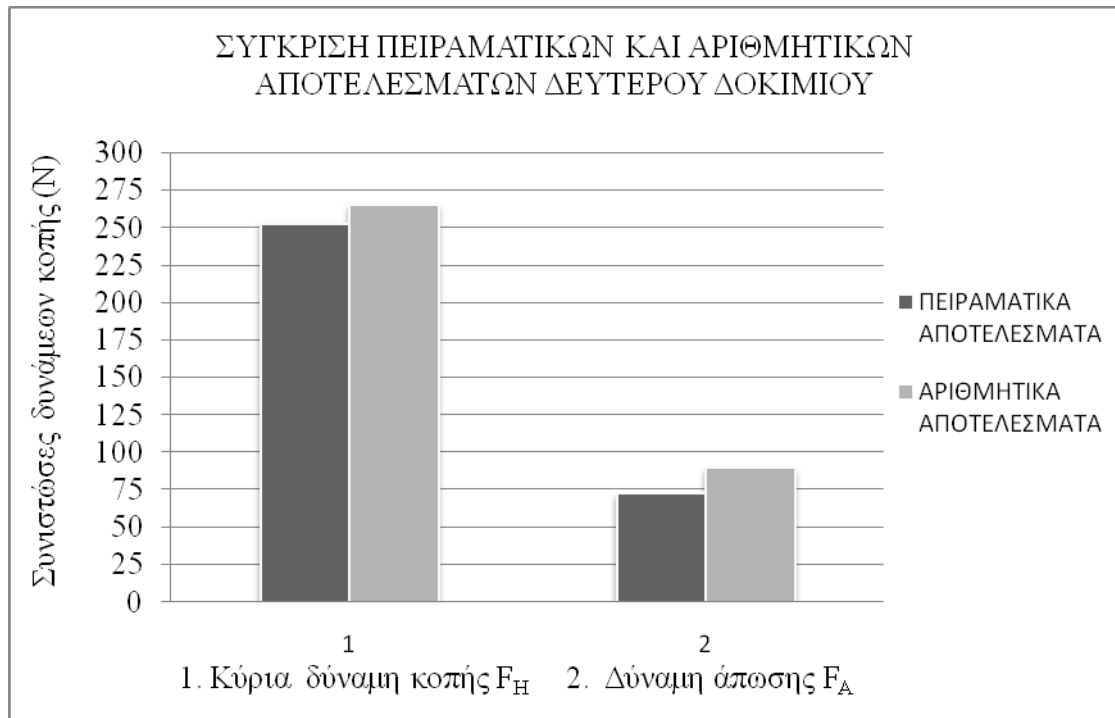
Σχήμα 7.3 Σύγκριση κύριας δύναμης κοπής F_H και δύναμης άπωσης F_A πειραματικών και αριθμητικών αποτελεσμάτων
