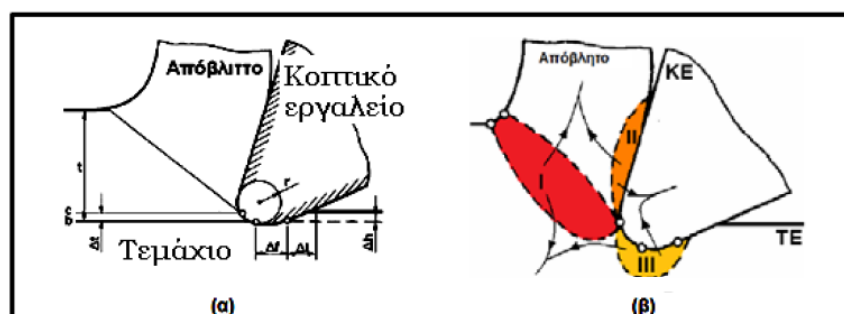
Σχήμα 2.7 Περιοχές παραγωγής θερμότητας κατά την κοπή και η συμβολή κάθε ζώνης στη διανομή της θερμότητας
