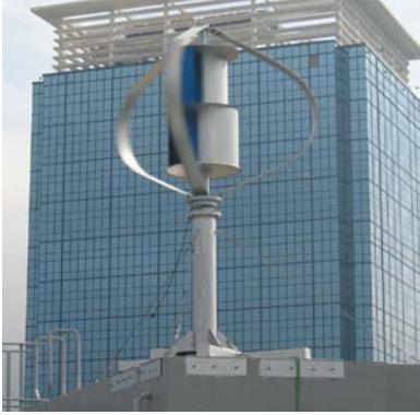
Σχήμα 16 Μικρή ανεμογεννήτρια 2.1kWh κάθετου άξονα[42]
