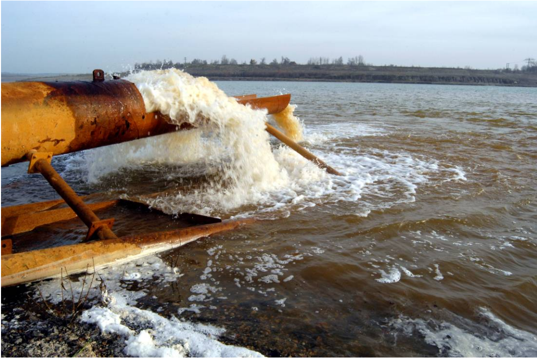
Εικόνα 7-1: Προβλήματα ποιότητας νερού από την οξείδωση Fe στο ορυχείο Tagebaus Zwenkau (Sachsen).
