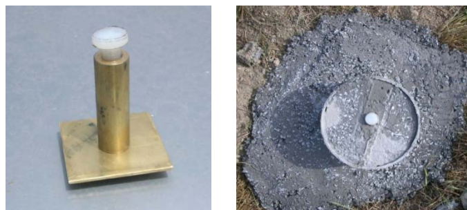
Εικόνα 7-7: Κατασκευή βάρων τοποθέτησης μεταφερόμενων στόχων
