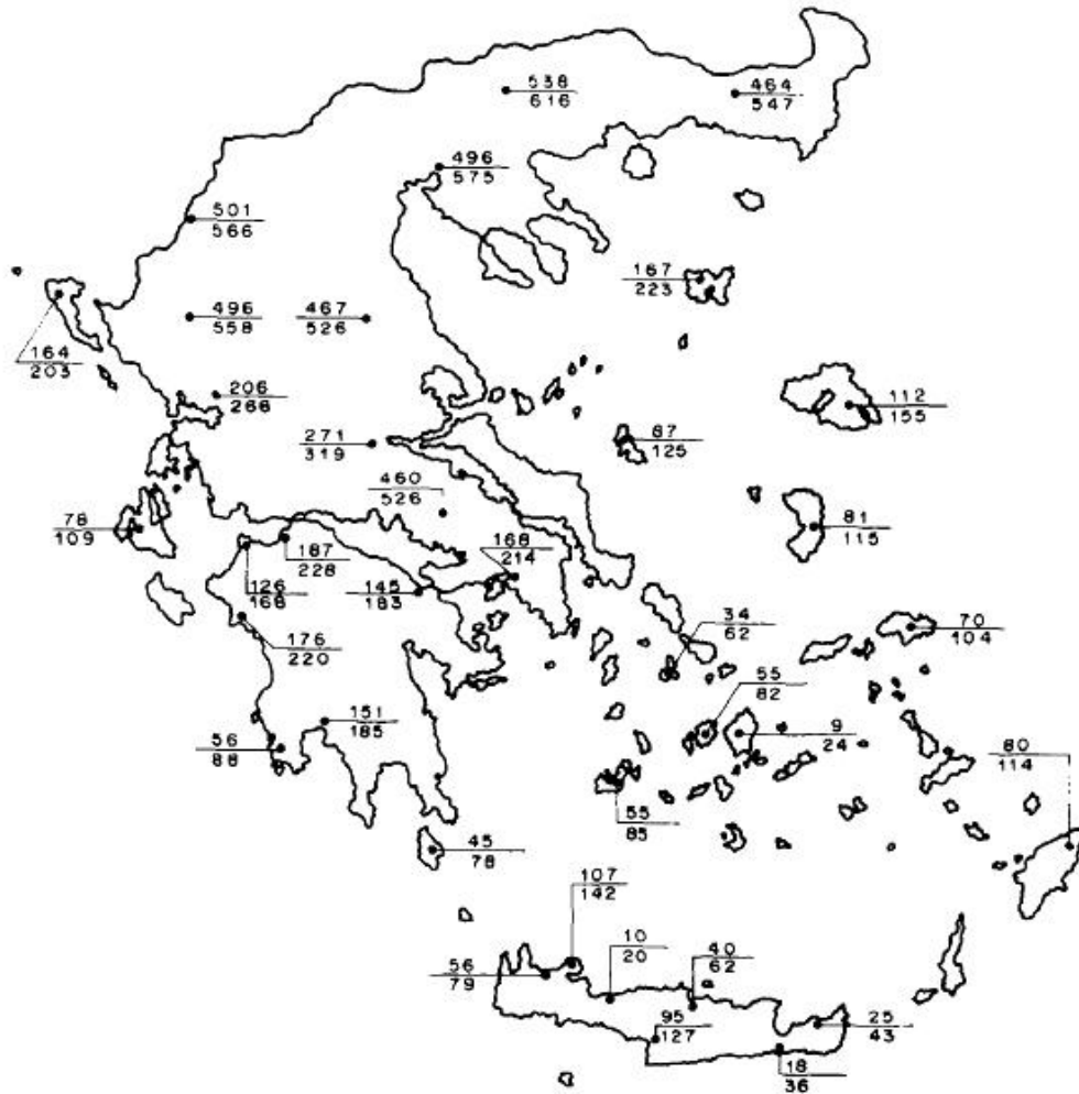
Εικόνα 11 : Κατανομή των αναγκών θέρμανσης για εσωτερική θερμοκρασία T_{in}=10^{\circ}\text{C} ( \text{MJ}/\text{m}^2 \text{ year} ). Οι τιμές πάνω από τις γραμμές αντιστοιχούν σε υαλόφρακτα θερμοκήπια και οι κάτω αντιστοιχούν σε πλαστικά. (Caouris, 1989)
