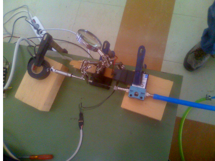
Σχήμα 5.4: Φωτογραφία της διάταξης του πειράματος θερμού νήματος
