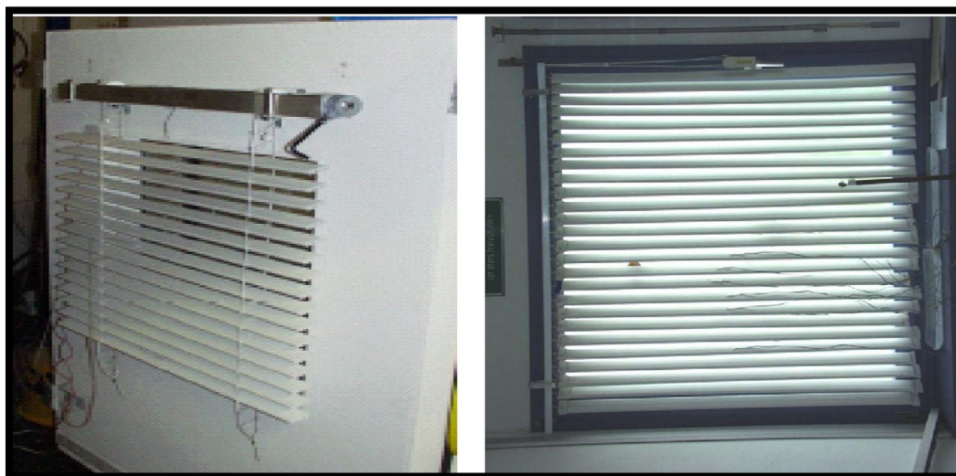
Εικόνα 5.4.1 Σκίαση με ρολά που περιέχουν PCM.
