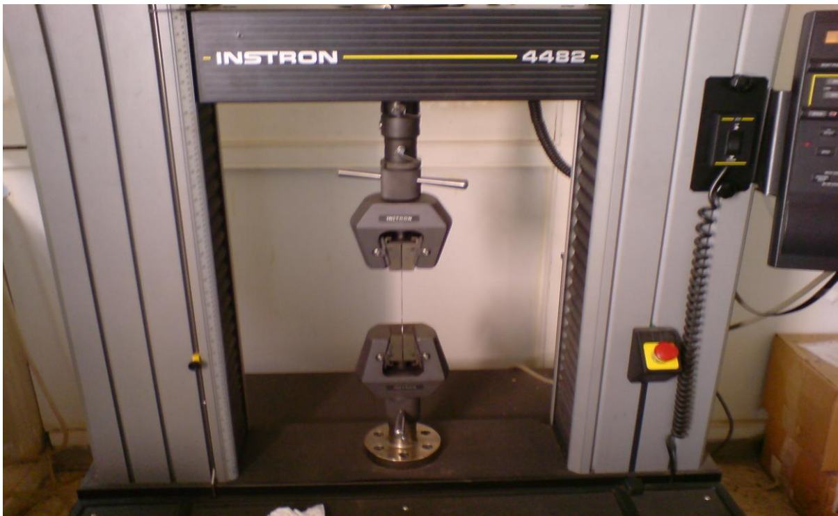
Εικόνα 42. Η μηχανή εφελκυσμού όπου υποβλήθηκαν τα δοκίμια σε εφελκυστική καταπόνηση.
