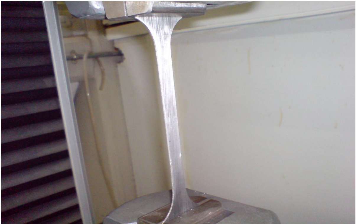
Εικόνα 44. Το δοκίμιο αρχίζει να καταπονείται εφελκυστικά.
