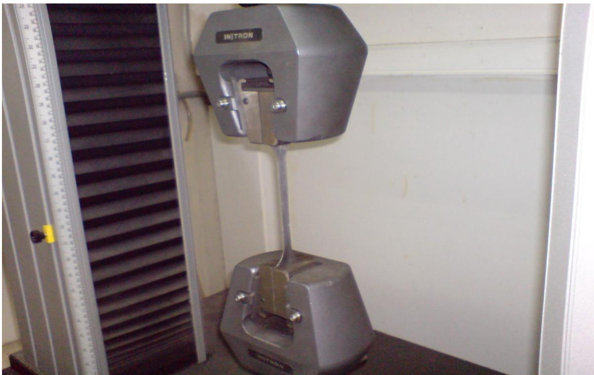
Εικόνα 43. Η μηχανή εφελκυσμού και ένα από τα δοκίμια έτοιμο για εφελκυστική καταπόνηση.
