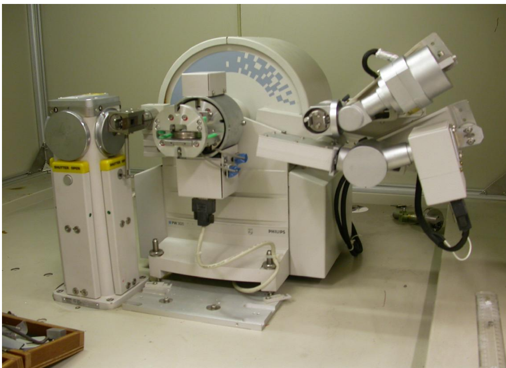
Εικόνα 3. Το περιθλασίμετρο του εργαστηρίου Επιστήμης και Τεχνολογίας Υλικών.
