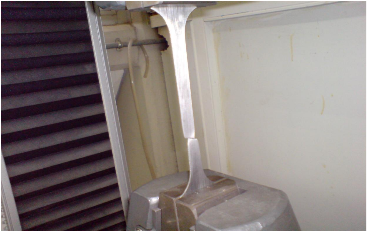
Εικόνα 47. Το πέρας της εφελκυστικής καταπόνησης με την θραύση του δοκιμίου.
