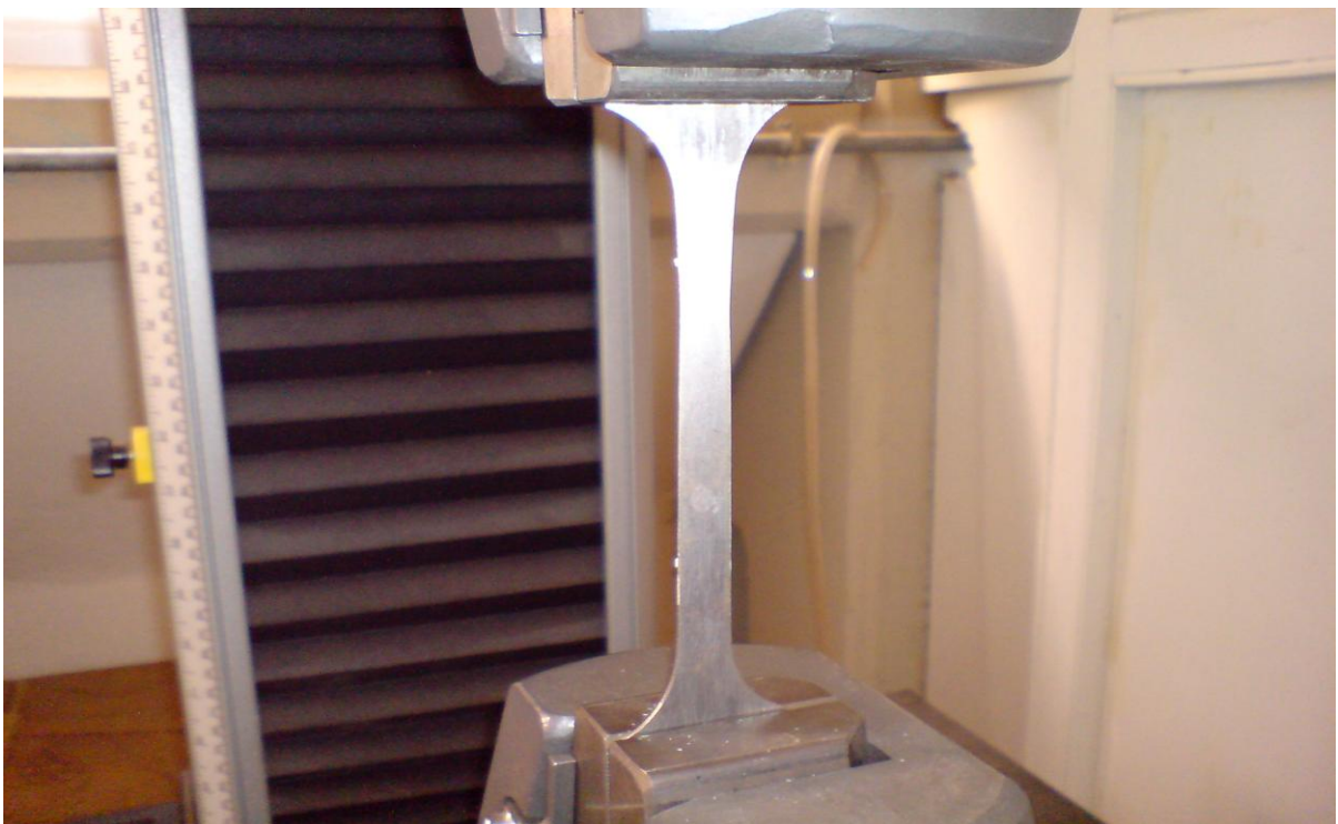
Εικόνα 45. Η εφελκυστική καταπόνηση βρίσκεται σε εξέλιξη.
