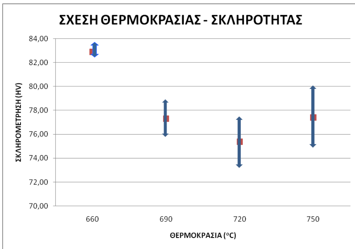
Εικόνα 2. Διάγραμμα σκληρότητας – θερμοκρασίας ανόπτησης.
