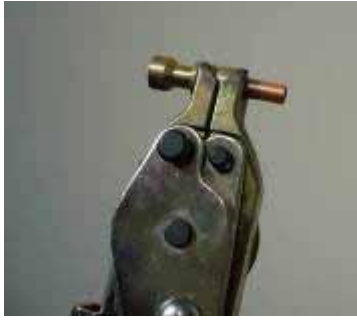
Η συναρμολόγηση συμπιέζεται, μέρος 2
