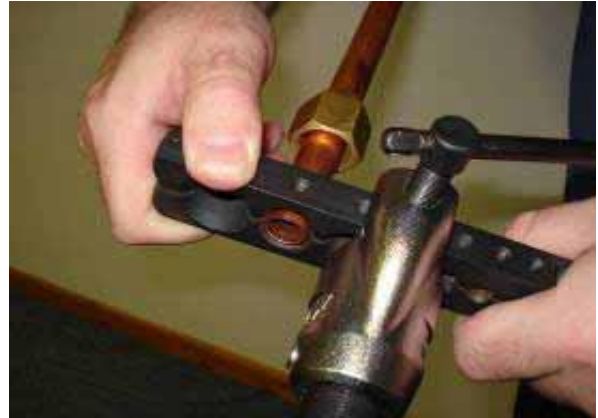
Η σωλήνα πρέπει να τοποθετηθεί στο σωστό άνοιγμα
