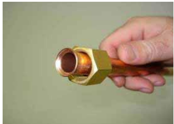
Η τελική διεύρυνση είναι λιγότερο επιφορτισμένη στη βάση της διεύρυνσης και λεπταίνει λιγότερο το πάχος στη κατάληξη της σωλήνας.
