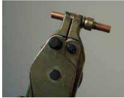
Η συναρμολόγηση συμπιέζεται, μέρος 3
