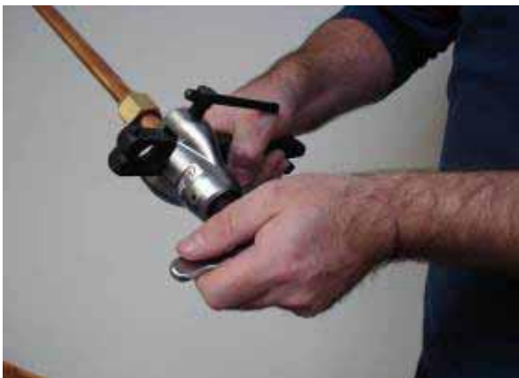
Το εργαλείο πρέπει να βιδωθεί προς τα μέσα – το πιάσιμο αποτρέπει υπερβολικό σφίξιμο και επομένως επιφόρτιση του σωλήνα
