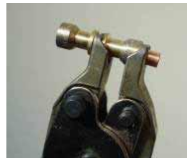
Η συναρμολόγηση συμπιέζεται, μέρος 1
