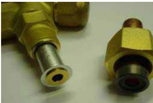
Οξυγονοκολλημένος αντάπτορας για προέκταση βαλβίδας
