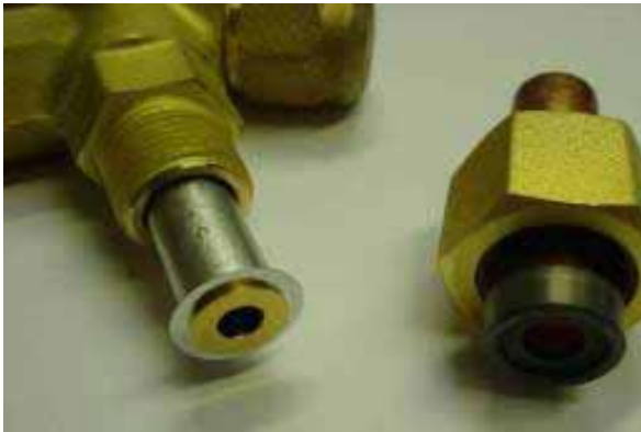
Οξυγονοκολλημένος αντάπτορας για προέκταση βαλβίδας
