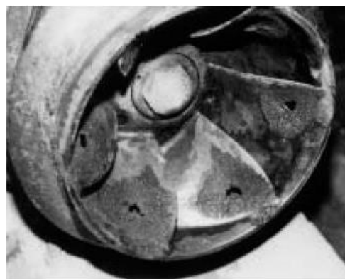
Σχήμα 9.1 Διάβρωση λόγω σπηλαιώσης στα πτερώγια μιας αντλίας μεικτής ροής (www.iapws.jp)
