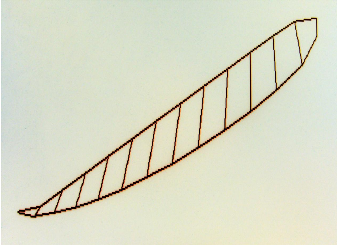
Εικόνα Π. 38: Σχηματική απεικόνιση ελεύθερης επιφάνειας, κρίσιμης επιφάνειας ολίσθησης και τμημάτων του οπλισμένου πρανούς με γωνία \beta = 30^\circ , οπλισμό 8 \text{ kN/m} και 13 στρώσεις οπλισμού (Παράδειγμα 25)
