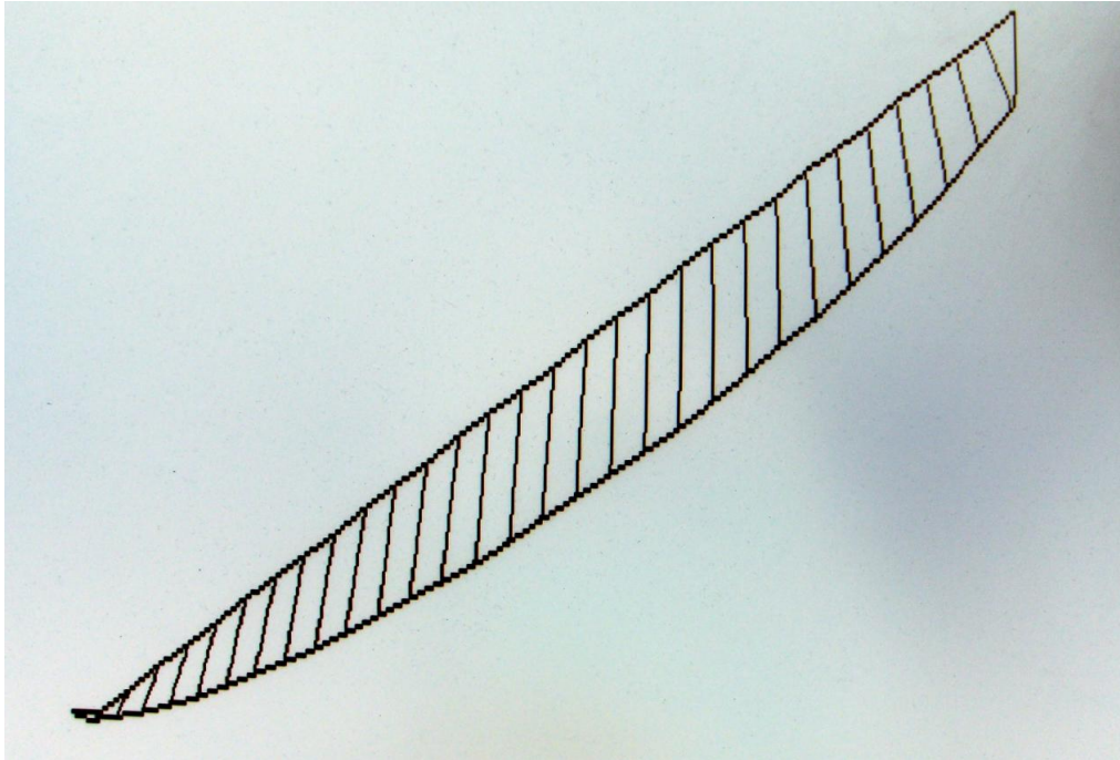
Εικόνα Π. 10: Σχηματική απεικόνιση ελεύθερης επιφάνειας, κρίσιμης επιφάνειας ολίσθησης και τμημάτων του πρανούς με γωνία \beta = 34^\circ (Παράδειγμα 10)
