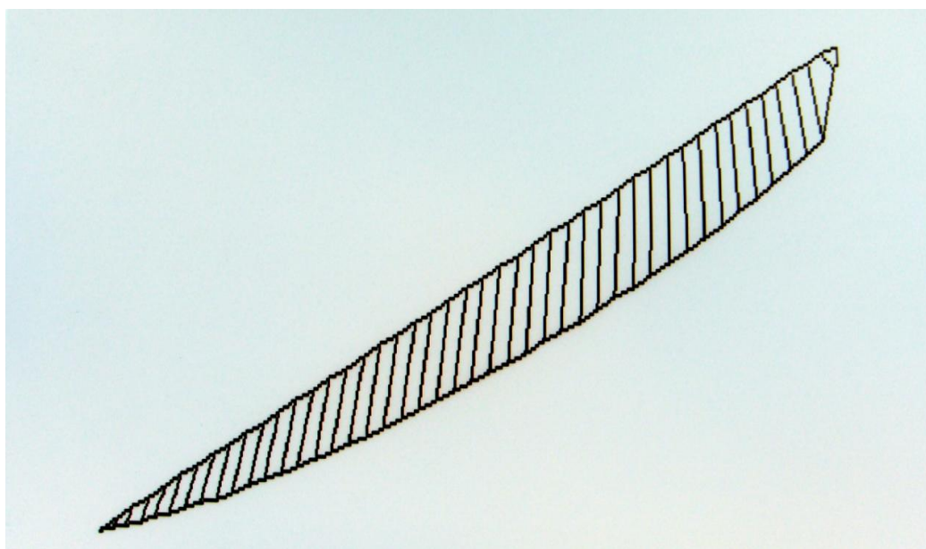
Εικόνα Π. 5: Σχηματική απεικόνιση ελεύθερης επιφάνειας, κρίσιμης επιφάνειας ολίσθησης και τμημάτων του πρανούς με γωνία \beta = 34^\circ (Παράδειγμα 7)
