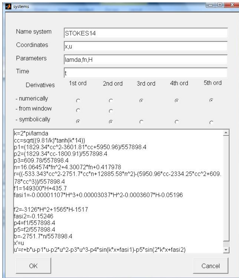
Σχ.7.7β Πρόγραμμα «σταθερού βάθους νερού d=14m , 2 ης τάξης κύματα»
