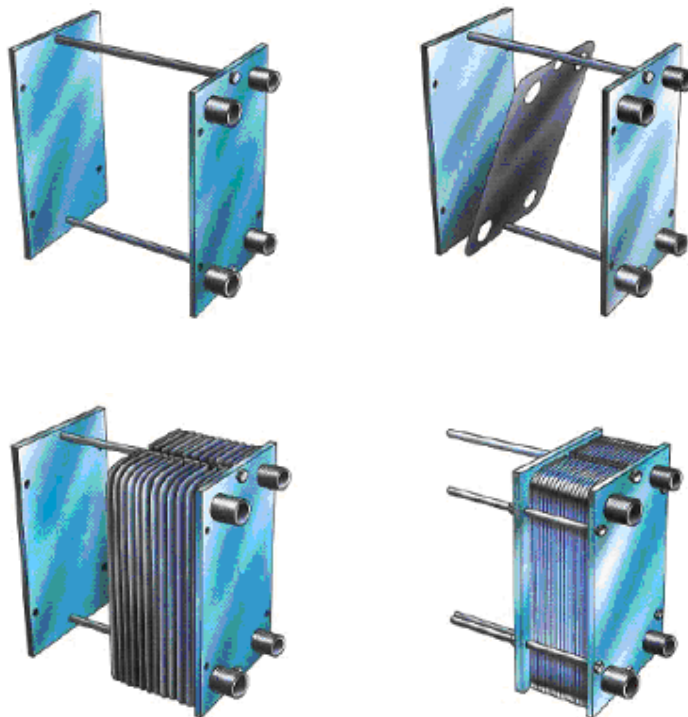
Σχήμα 3.4. Τα βήματα συναρμολόγησης ενός πλακοειδή εναλλάκτη θερμότητας [16]
