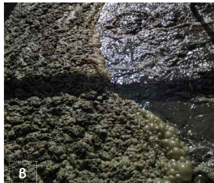
Εικόνα 2.6: Νηματοειδής αφρισμός με διαφορετικά χαρακτηριστικά σε επιμέρους στάδια της επεξεργασίας ενεργού ιλύος. Οι εικόνες α, β είναι από τις δεξαμενές βιολογικής επεξεργασίας, η α από το ανοξικό διαμέρισμα και η β από το διαμέρισμα αερισμού.
