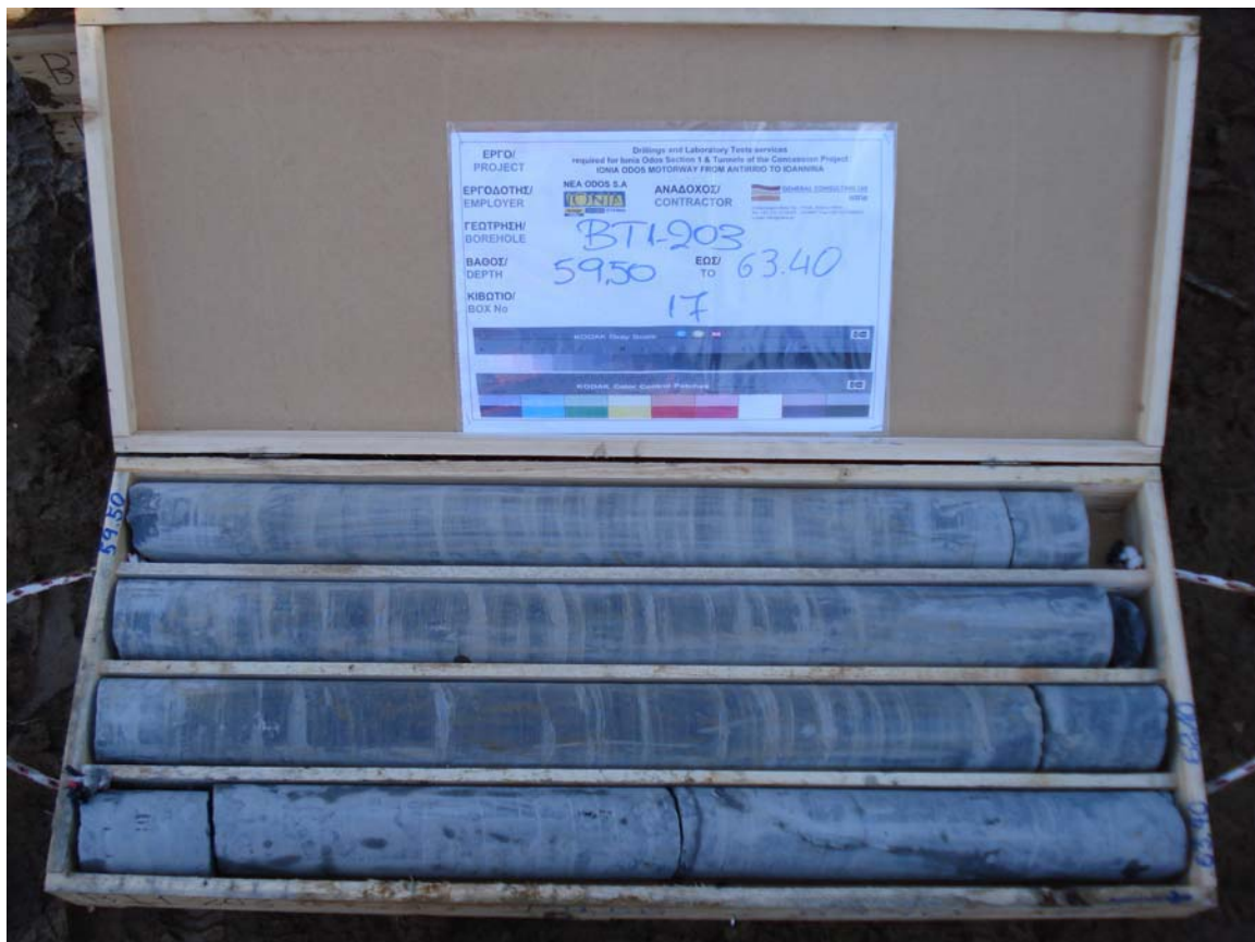
Γεώτρηση BT1-203 Βάθος 59.50 – 63.40 μ. Κιβώτιο 17
