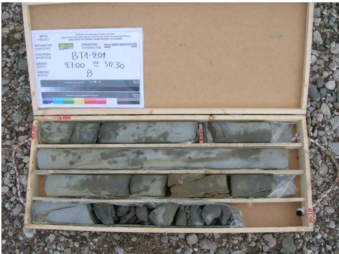
Γεώτρηση BT1-201 Βάθος 27.00 – 30.30 μ. Κιβώτιο 8
