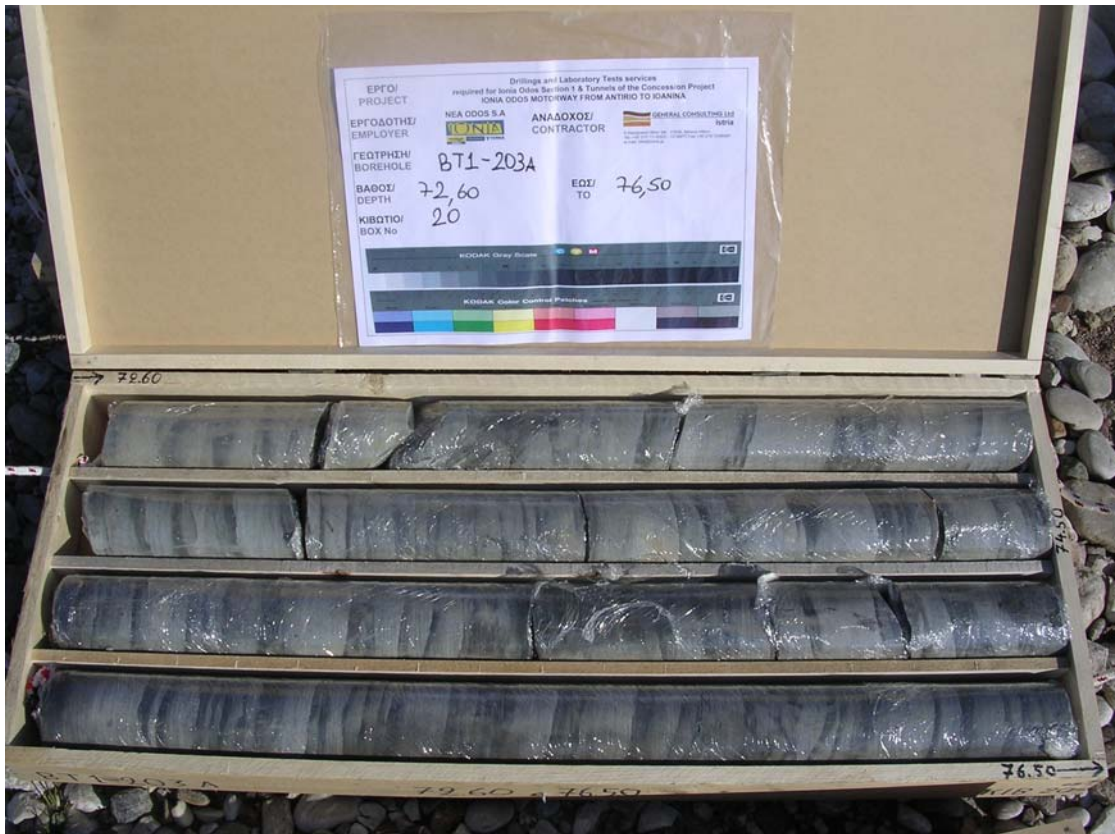
Γεώτρηση BT1-203A Βάθος 72.60 – 76.50 μ. Κιβώτιο 20
