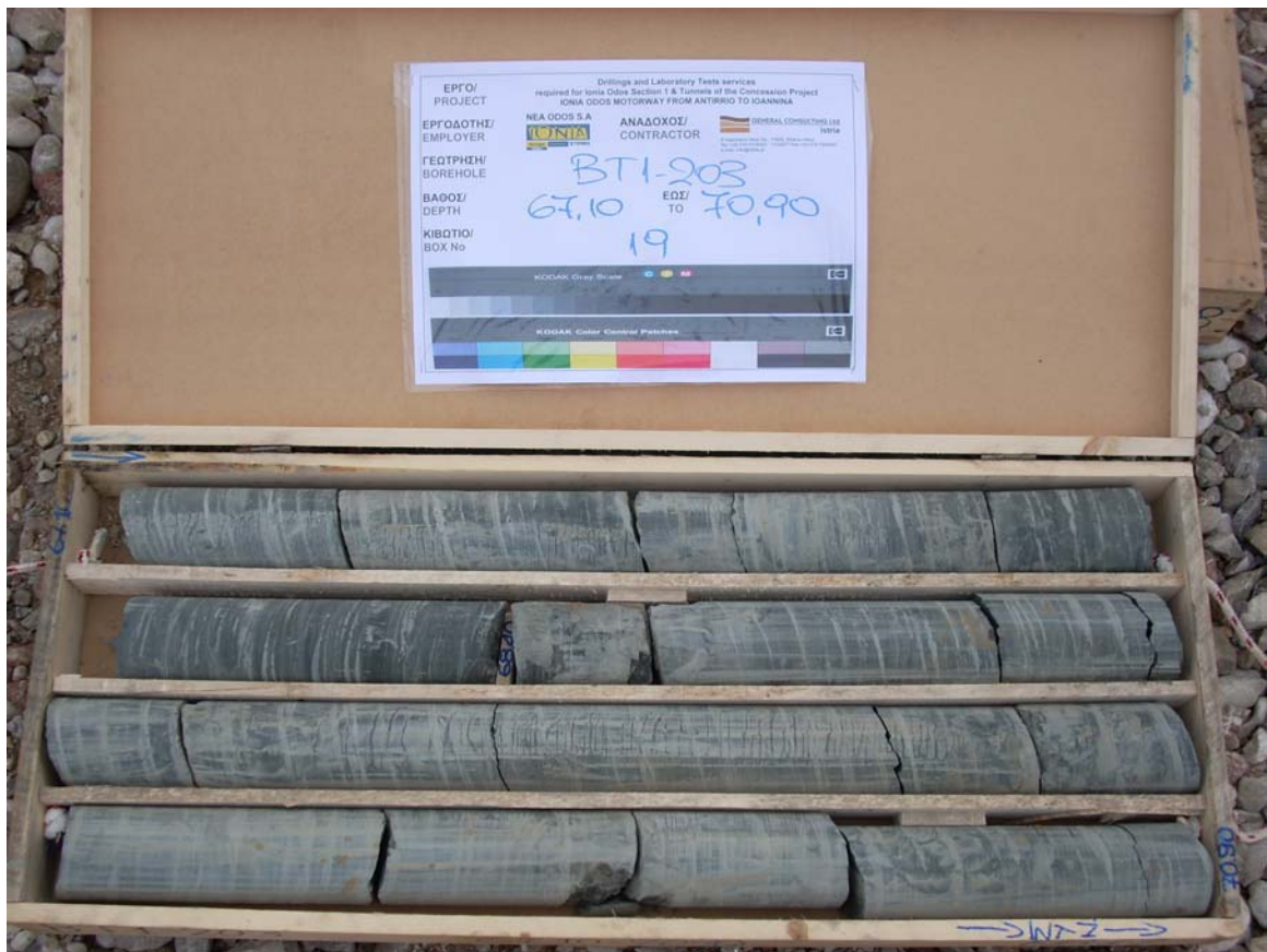
Γεώτρηση BT1-203 Βάθος 67.10 – 70.90 μ. Κιβώτιο 19
