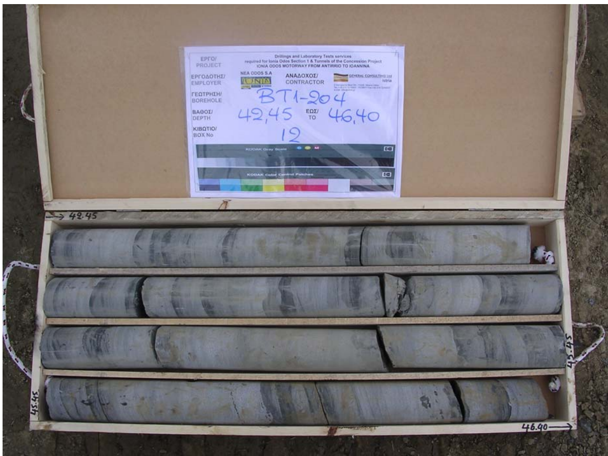
Γεώτρηση BT1-204 Βάθος 42.45 – 46.40 μ. Κιβώτιο 12
