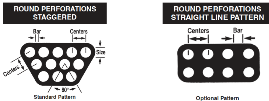
Εικόνα 54 - Διάτρητη λαμαρίνα με διάταξη οπών "ζικ-ζακ" Εικόνα 55 - Διάτρητη λαμαρίνα με διάταξη οπών ευθεία
