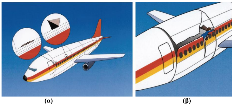
Σχήμα 6: (α) Πιθανή εκκίνηση της βλάβης σε περιοχή υψηλής καταπόνησης του κατασκευαστικού στοιχείου (β) απότομη θραύση μέρους της ατράκτου του αεροπλάνου τύπου Boeing 737 της πτήσης 243 της Aloha Airlines [11].
