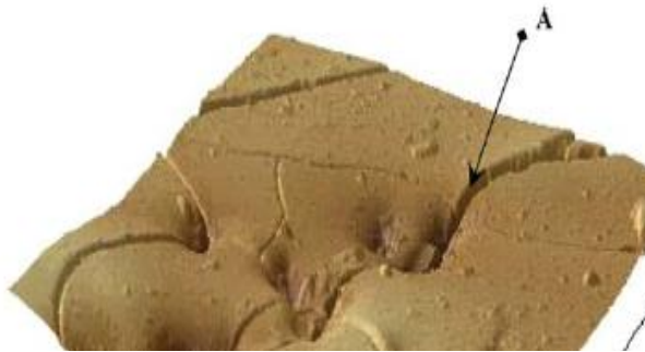
Σχήμα 4: Έναρξη περικρυσταλλικής διάβρωσης σε δοκίμιο κράματος 2024 T3 [10].
