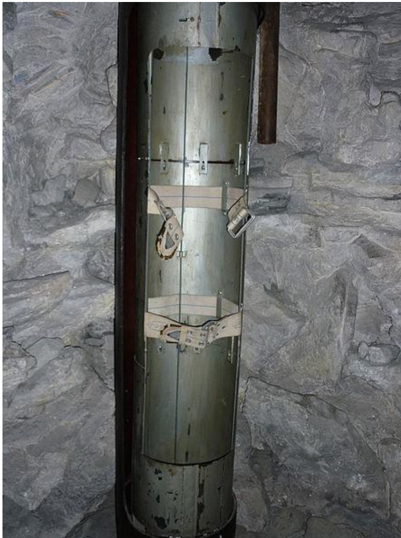
Εικόνα 2.10. Η πρωτότυπη κάψουλα διάσωσης Dahlbusch-Bombe, όπως βρίσκεται στο Εθνικό Μουσείο του Μονάχου. (Πηγή : Wikipedia, the free encyclopedia)
