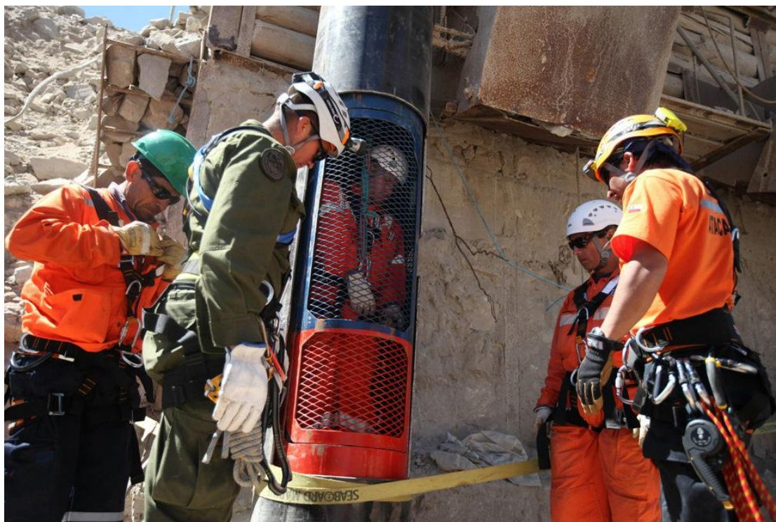
Εικόνα 7.11. Εικόνα από τη δοκιμαστική κύλιση της κάψουλας εντός των σωλήνων επένδυσης. (Πηγή : Διαδίκτυο)
