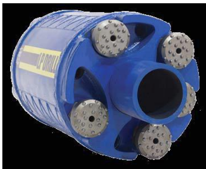
Εικόνα 3.11. Η ειδική κεφαλή LP Drill του “Schramm T-130 XD” του σχεδίου διάσωσης Β. (Πηγή : Διαδίκτυο)
