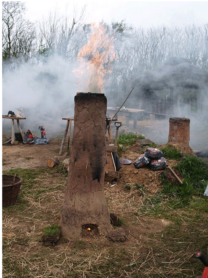
Εικόνα 23. Σύγχρονη κατασκευή καμίνου σφυρηλασίας συντήγματος ( www.warehamforge.ca ).
