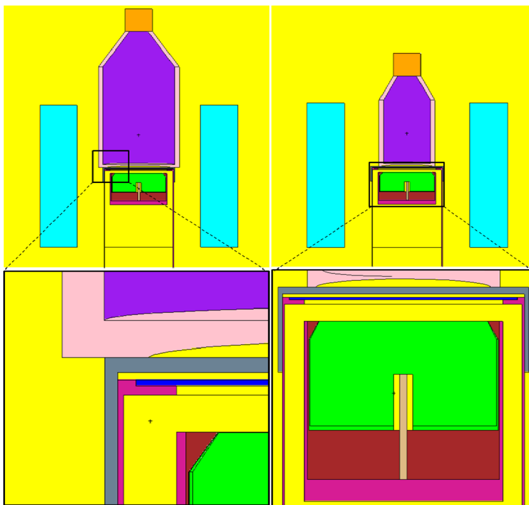
Σχήμα 5.13. Σχηματική αναπαράσταση της προσομοιωμένης ανιχνευτικής διάταξης HPGe για τις γεωμετρίες μεγάλης και μικρής φιάλης σε επαφή, με το πρόγραμμα γραφικών VisED.
