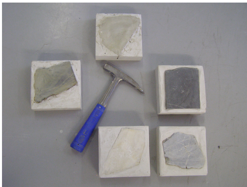
Εικόνα 3.8. Διαμορφωμένες επιφάνειες πρόσκρουσης.
