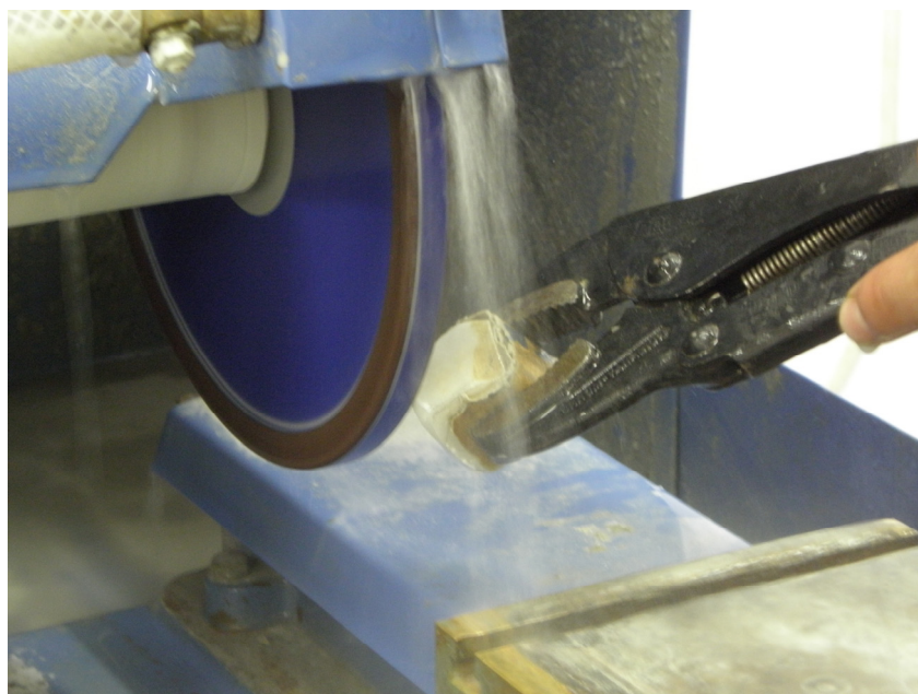
Εικόνα 3.9. Διαδικασία λείανσης τεμαχών.
