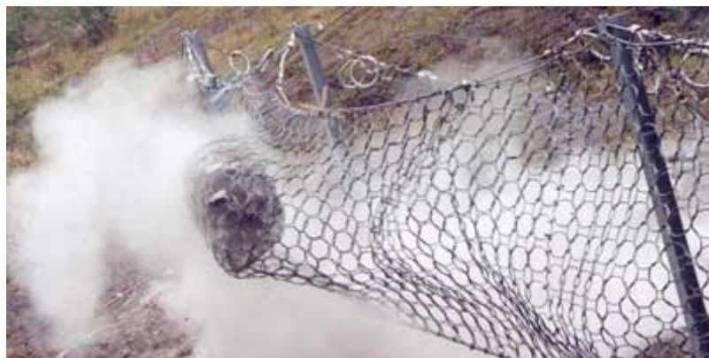
Εικόνα 2.3. Φράκτης συλλογής βραχοτεμαχίων (πηγή Geobrugg)
