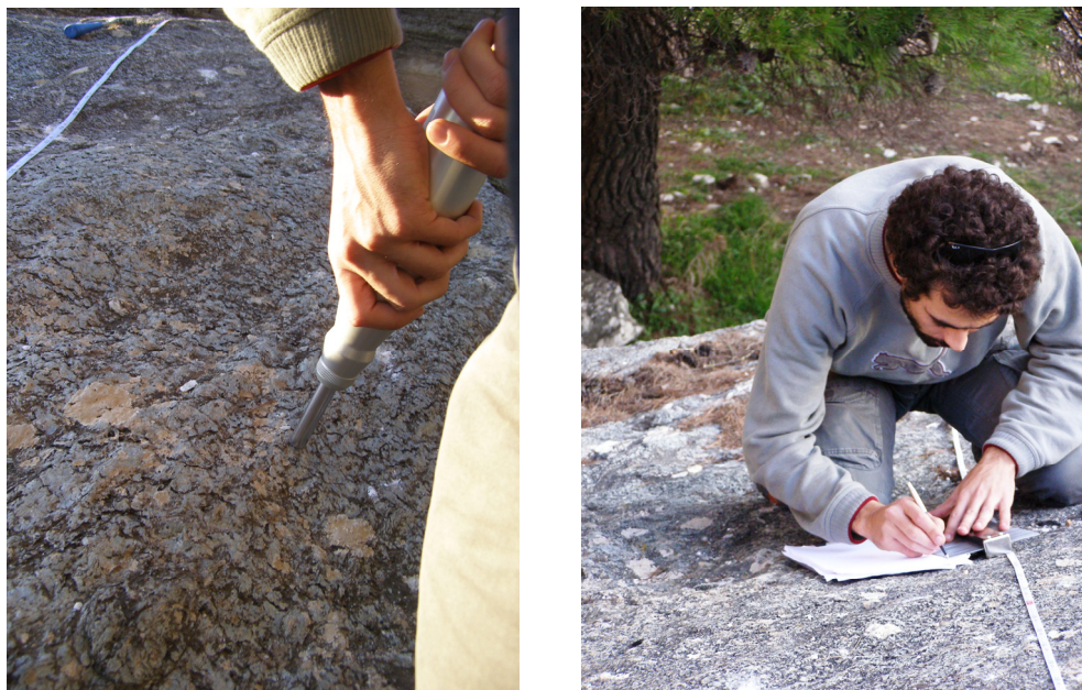
Εικόνα 5.7. Γεωλογική αποτύπωση πρανούς. Μέτρηση σκληρότητας με την σφύρα Schmidt (αριστερά) και προφίλομέτρηση (δεξιά)
