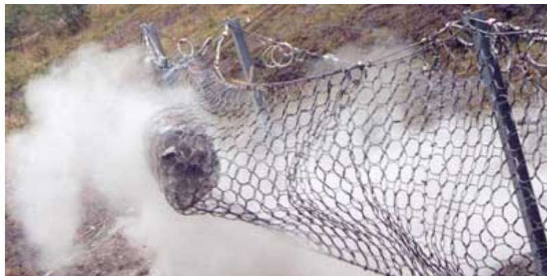
Εικόνα 2.3. Φράκτης συλλογής βραχοτεμαχίων (πηγή Geobrugg)
