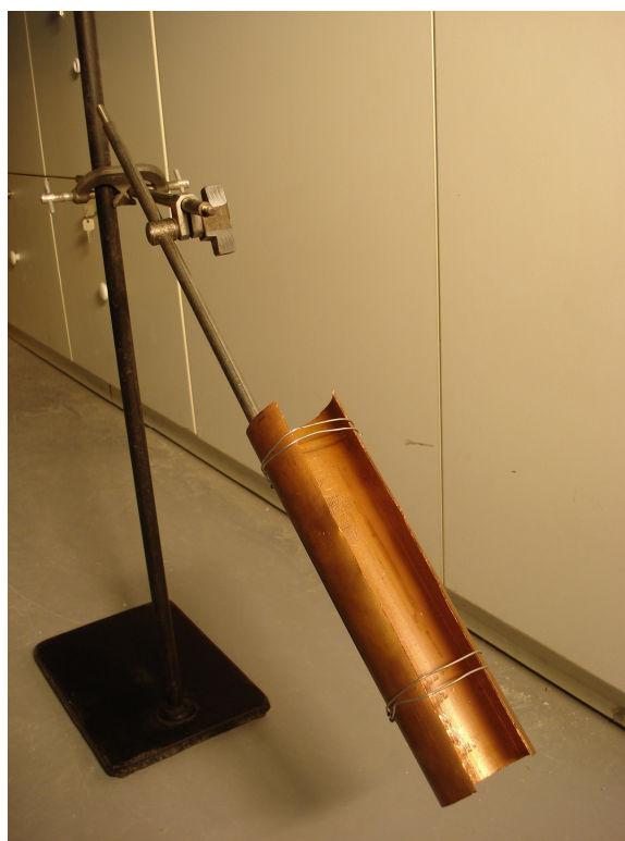
Εικόνα 3.5. Διάταξη συστήματος ρίψεως για δοκιμές παραβολικής ρίψης
