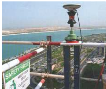
Εικόνα 35: Δέκτης GNSS που λειτουργούσε σαν ενεργό σημείο ελέγχου κατά τη διάρκεια της κατασκευής του πύργου Landmark στο Abu Dhabi.
