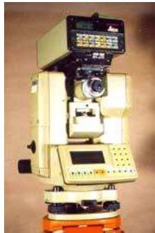
Εικόνα 11: Το αποστασιόμετρο Dior 3002S προσαρμοζόμενο στο ψηφιακό θεοδόλιχο T1610 και ο γεωδαιτικός σταθμός TC702 (Leica)
