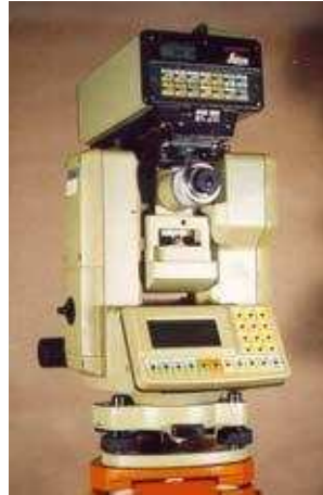
Εικόνα 26: Το αποστασιόμετρο Diors3002S προσαρμοζόμενο στο ψηφιακό θεοδόλιχο T1610
