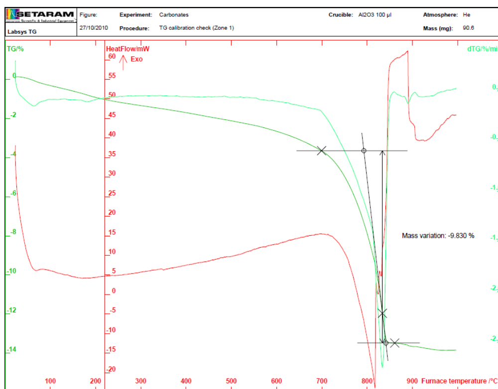
Σχήμα 6-9. Διάγραμμα διαφορικής θερμικής ανάλυσης (DTA) ενανθρακωμένης ιπτάμενης τέφρας
