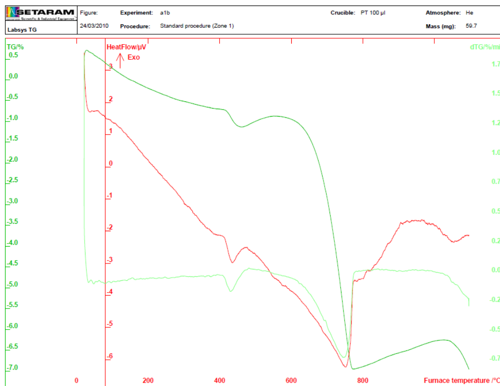
Σχήμα 5-8. Διάγραμμα διαφορικής θερμικής ανάλυσης (DTA) ιπτάμενης τέφρας
