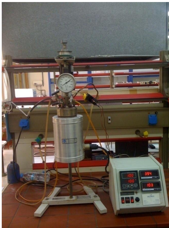
Εικόνα 4-2. Αυτόκλειστο εργαστηριακών δοκιμών ενανθράκωσης
