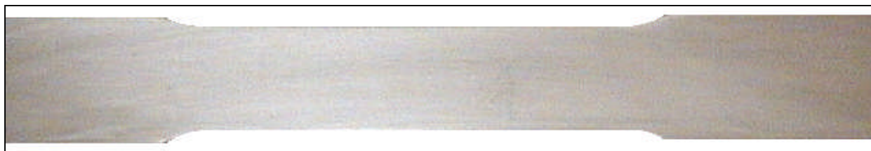
Εικόνα 3.3 : Η επιφάνεια του δοκιμίου μετά τη λείανση και τον καθαρισμό με τον φυσικό διαλύτη.
