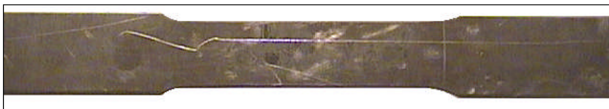
Εικόνα 3.2 : Η επιφάνεια του δοκιμίου πριν υποστεί λείανση και καθαρισμό.
