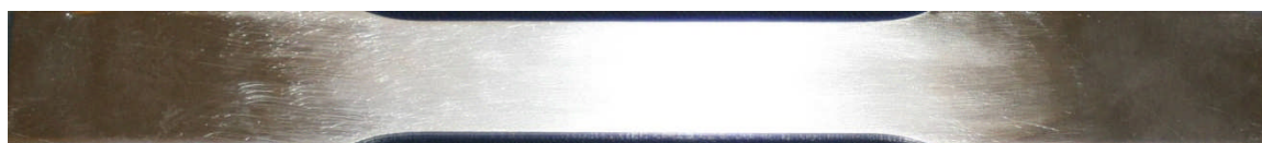
Εικόνα 3.5: Δοκίμιο από αλουμίνιο 5083 που χρησιμοποιήθηκε στα πειράματα
