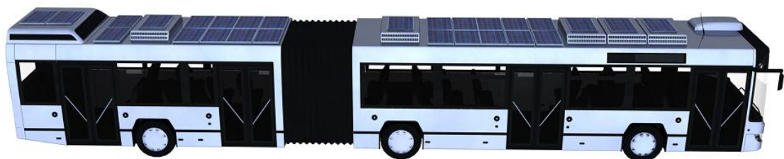
Σχήμα 37: Οριζόντια πάνω όψη της Φ/Β εγκατάστασης στην οροφή του λεωφορείου
