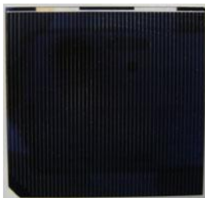
Σχήμα 12: Φ/Β πλαίσιο από αρσενικούχο γάλλιο, για διαστημική αποστολή
