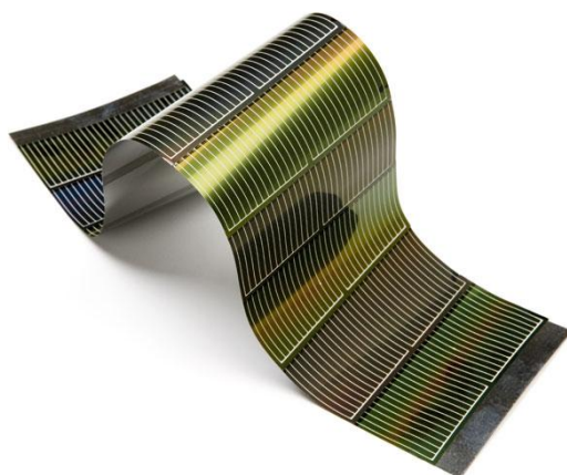
Σχήμα 11: Φ/Β στοιχείο από τελλουριούχο κάδμιο
