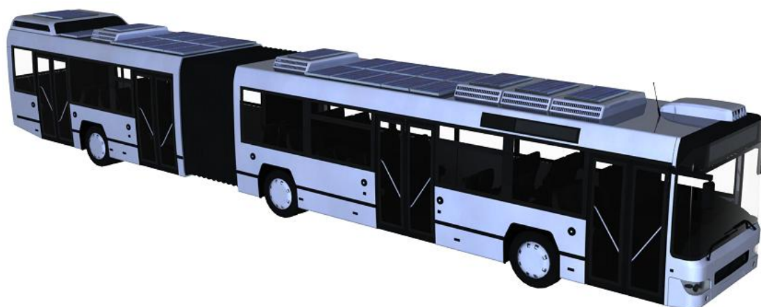
Σχήμα 34: Πλάγια όψη της Φ/Β εγκατάστασης στην οροφή του λεωφορείου
