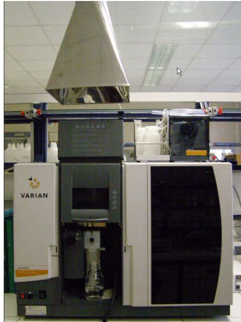
Εικόνα 6.2: Πρόσωση συσκευής οργάνου AAS (Atomic Absorption Spectrophotometer)
