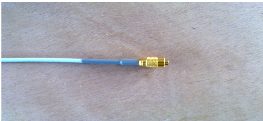
Σχ. 45. Απόληξη του καλωδίου των αισθητήρων εγγύτητας: εξωτερική διάμετρος 7.23 mm.
