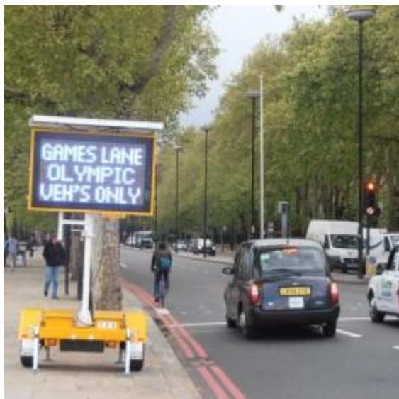
Εικόνα 2.7: Φορητή πινακίδα μεταβλητών μηνυμάτων
