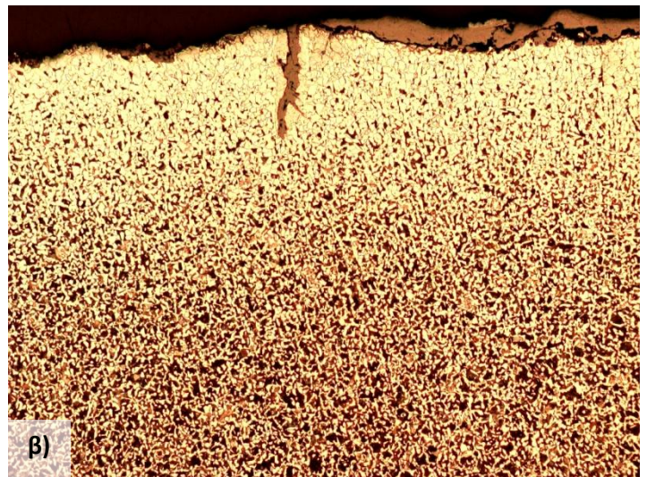
Εικόνα 15: Μικρογραφίες οπτικού μικροσκοπίου δοκιμίων χάλυβα φερριτοπερλικής δομής, στις οποίες παρατηρείται έντονα το φαινόμενο της απανθράκωσης. Στη φωτογραφία β) το βάθος της απανθράκωσης φαίνεται να είναι ίσο με το μήκος της ρωγμής που έχει σχηματιστεί εντός της ζώνης απανθράκωσης. (Πηγή: Δρ. Σπ. Παπαευθυμίου, ΕΛ.Κ.Ε.ΜΕ. Α.Ε.)
