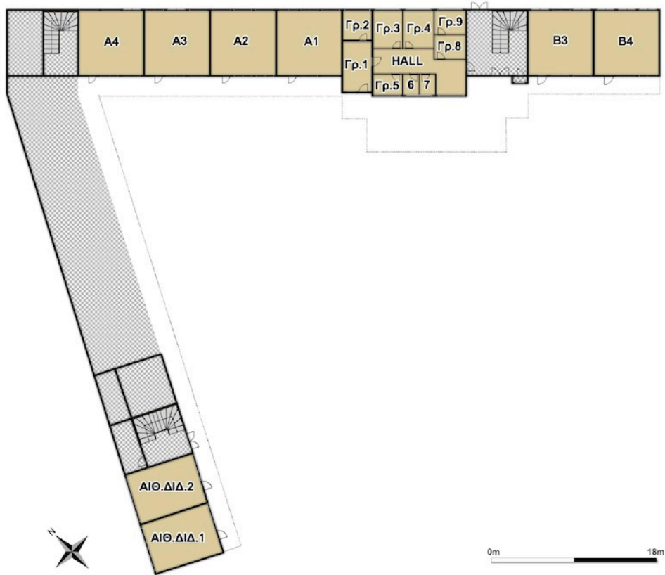
Εικόνα 17: Κάτοψη Ισογείο Δημοτικό
