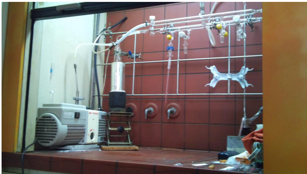
Σχήμα 58. Στην εικόνα παρουσιάζεται η διάταξη κενού που χρησιμοποιήθηκε στην παρούσα μελέτη.
