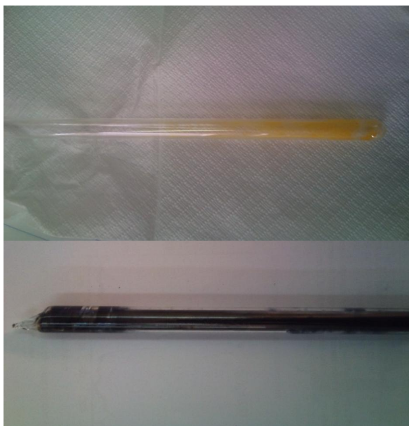
Εικόνα 2. Στο πάνω μέρος απεικονίζεται ο σωλήνας χαλαζία που εμπεριέχει το μίγμα προς θερμόλυση και στο κάτω μέρος ο ίδιος σωλήνας μετά τη θερμόλυση και ολοκλήρωση της πειραματικής διαδικασίας.
