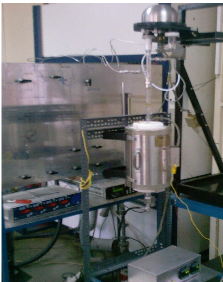
Σχήμα 27. Απεικόνιση διάταξης ανάπτυξης CNTs με τη μέθοδο της θερμικής χημικής εναπόθεσης με ατμό.
