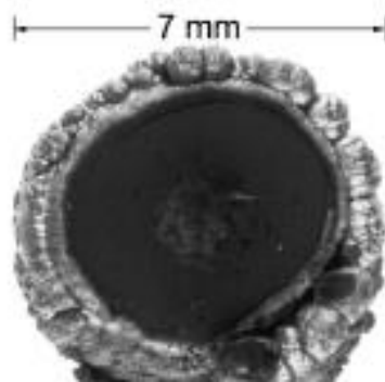
Σχήμα 18. Διατομή εναποτιθέμενου υλικού στην κάθοδο.
