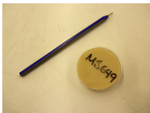
Σχήμα 4.9 Ρητίνη ανταλλαγής κατιόντων σε πλαστικό τριβλίο.
