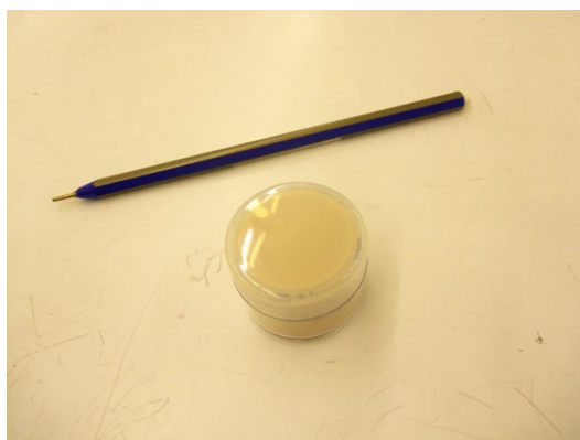
Σχήμα 4.8 Ρητίνη ανταλλαγής κατιόντων σε δοχείο που χρησιμοποιείται στο ΕΠΤ-ΕΜΠ για νευτρονική ενεργοποίησης.
