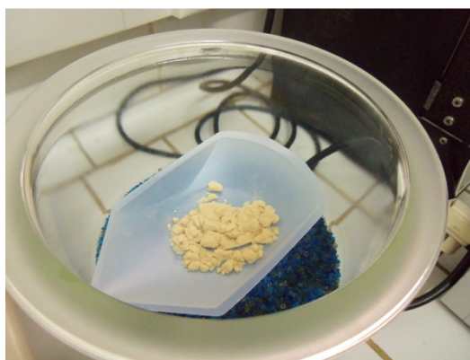
Σχήμα 4.6 Ρητίνη ανταλλαγής κατιόντων σε θάλαμο με silica gel
