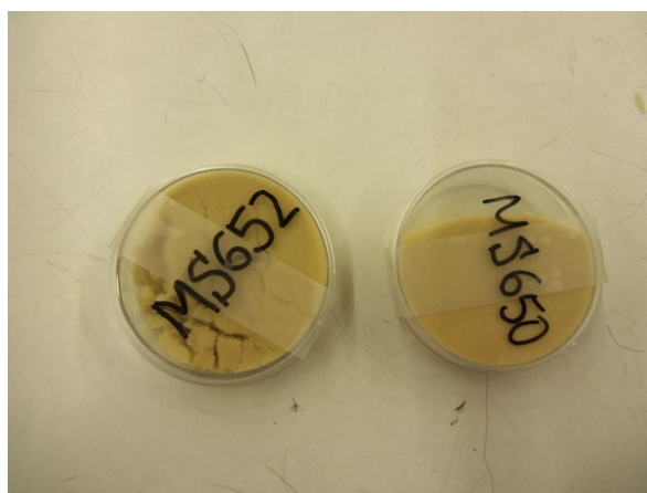
Σχήμα 4.10 Ρητίνη ανταλλαγής κατιόντων σε πλαστικά τριβλία μετά την πάροδο 3 μηνών από τη συσκευασία
