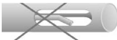
Σχήμα 4.11: Λανθασμένη θέση του θερμοστοιχείου
