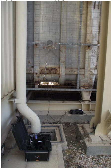
Σχήμα 4.13:τοποθέτηση του TESTO 350 στην έξοδο του στροβίλου.
