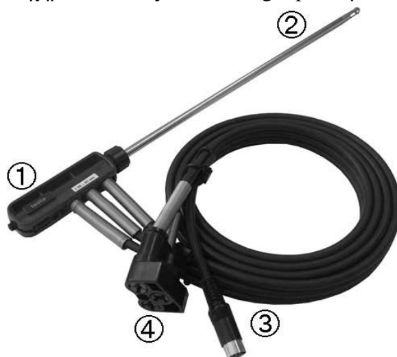
Σχήμα 4.9: Τα μέρη του flue gas probe
