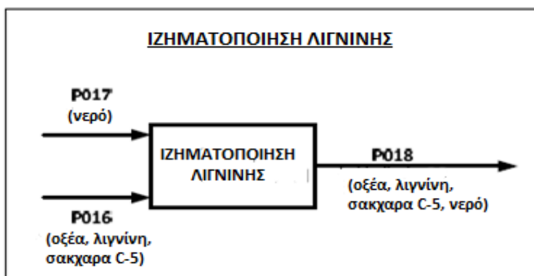
Σχήμα 21: Εννοιολογικό διάγραμμα μονάδας ιζηματοποίησης
