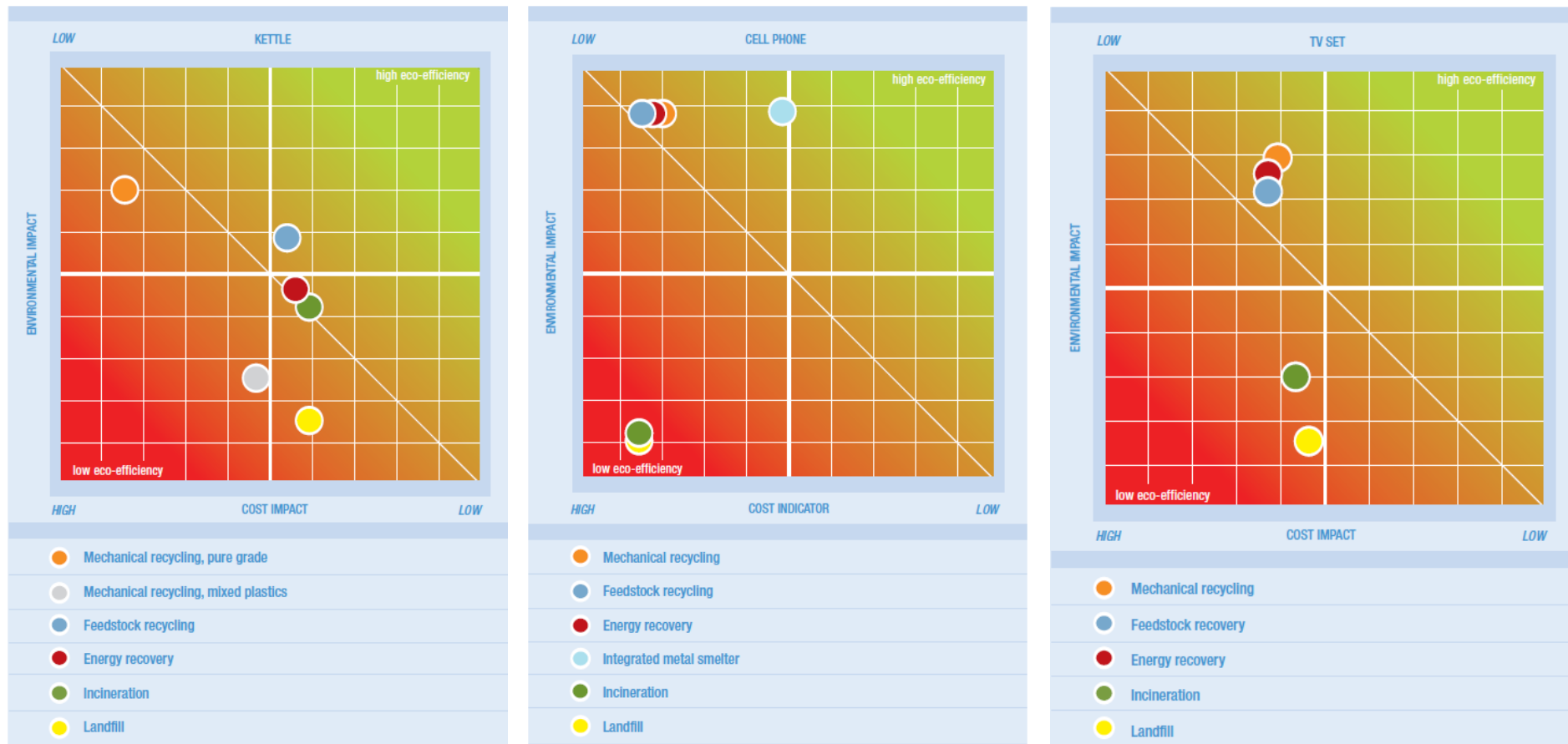
Σχήμα 2.3.4. Συγκριτικά διαγράμματα της σχέσης κόστους – περιβαλλοντικών επιπτώσεων των διαφόρων μεθόδων διαχείρισης συγκεκριμένων προϊόντων ΗΗΕ (ηλεκτρικός βραστήρας, κινητό τηλέφωνο και τηλεόραση). Παρατηρείται ότι αναλόγως της σύστασης των ΑΗΗΕ, προτείνεται ως αποτελεσματικότερη διαφορετική μέθοδος διαχείρισης. Χαρακτηριστικό είναι ότι η πλούσια σε πολύτιμα μέταλλα σύσταση του κινητού τηλεφώνου επιτρέπει τη χρήση τεχνολογιών όχι ιδιαίτερα φιλικών στο περιβάλλον, οι οποίες όμως επιτρέπουν την πλήρη ανάκτηση αυτών των ακριβών υλικών (PlasticsEurope, 2005).
