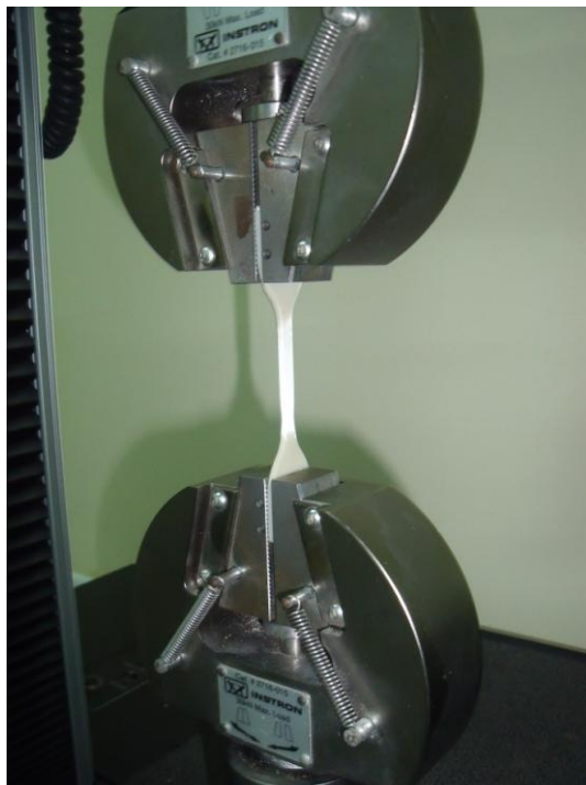
Σχήμα 4.3.8.4. Πραγματοποίηση πειραμάτων εφελκυσμού με τη συγκεκριμένη συσκευή Instron
