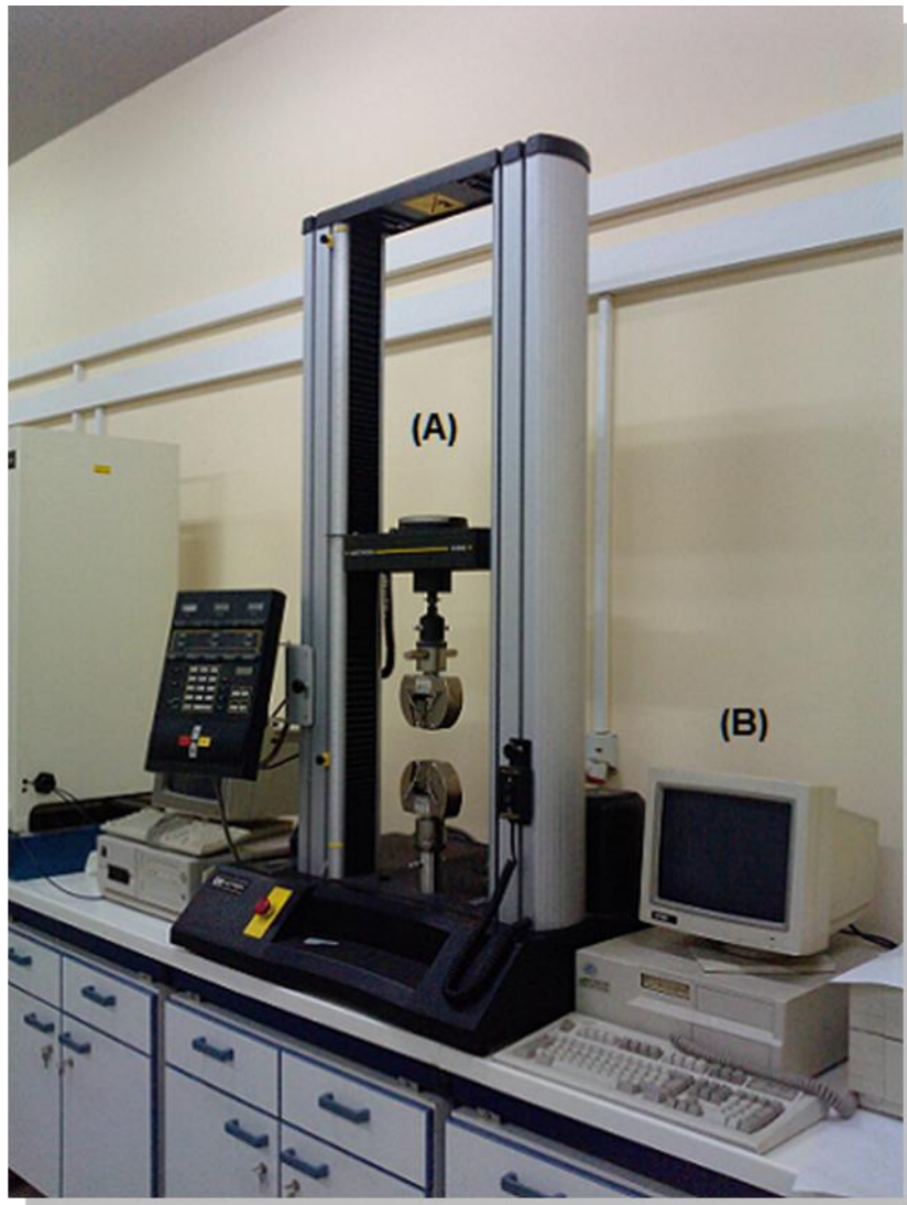
Σχήμα 4.3.8.2. Μηχανή εφελκυσμού Instron. Α) κεντρική μονάδα Instron, Β) ηλεκτρονικός υπολογιστής καταγραφής και χειρισμού της μηχανής.
