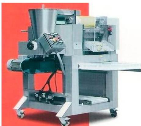
Εικόνα 18: Παράδειγμα πρέσας για συνεχή παραγωγή ζυμαρικών ( http://www.archiexpo.com/prod/dominioni/commercial-combined-pasta-dough-machines-68825-563495.html )
