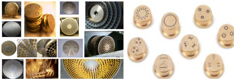
Εικόνα 16: Κεφαλές εκβολής ζυμαρικών σε ποικίλα σχήματα ( http://www.enginsoft.com/assets/img/casestudy/pasta/pasta_05.jpg , http://london.kijiji.ca/c-ViewAdLargeImage?AdId=526550784 )
