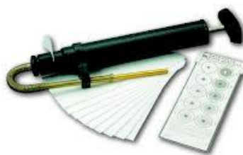
Εικόνα 4.3 : Ειδική τρόμπα για μέτρηση του δείκτη αιθάλης[14]
