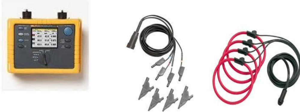
Εικόνα 4.4 : Ο αναλυτής ηλεκτρικής ενέργειας Fluke 1735 και οι ακροδέκτες μέτρησης τάσης και ρεύματος[15]
