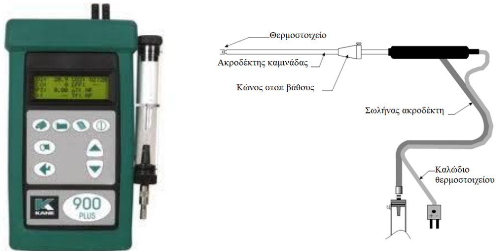
Εικόνα 4.2: Αναλυτής καυσαερίων και ακροφύσιο δειγματοληψίας [13]
