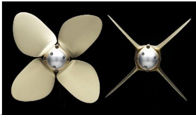
Σχήμα 1-3 Προπέλα μεταβλητού βήματος 4 πτερυγίων σε δύο διαφορετικές θέσεις, της Variprop
