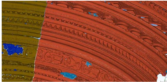
Εικόνα 4.21: Πολύπλοκη επιφάνεια (τόξα) με πολλά λάθη και κενά
