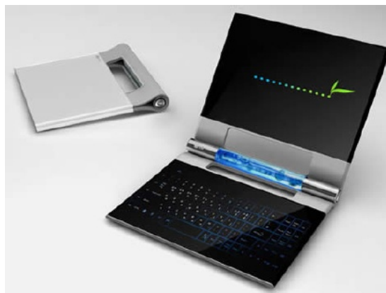
Εικόνα 2-5: Laptop με κυψέλες καυσίμου μεθανόλης (DMFC)
