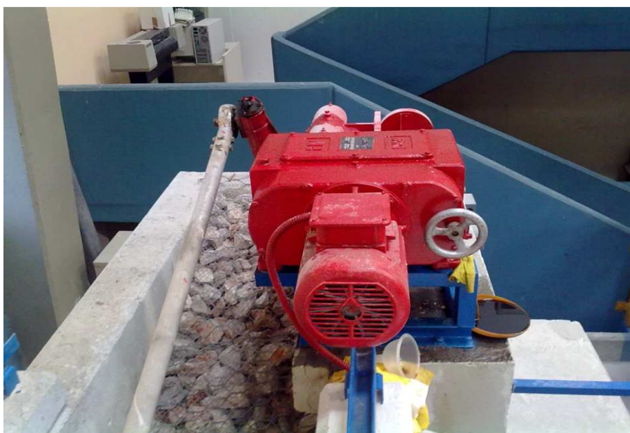
Εικόνα 5.3: Κυματογεννήτρια στο άκρο της διώρυγας τοποθετημένη στο βάθρο.
