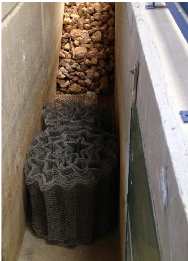
Εικόνα 5.7: Απορροφητικό στρώμα κυλινδρικών στοιβάδων-συρματοπλεγμάτων
