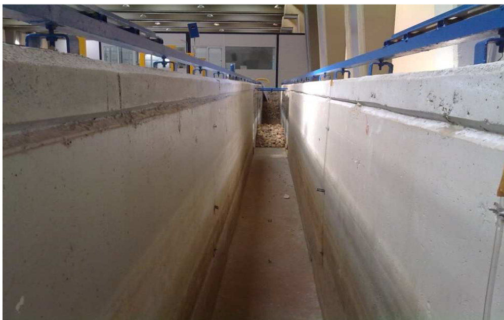
Εικόνα 5.2: Άποψη του εσωτερικού της διώρυγας βαρύτητας του εργαστηρίου λιμενικών έργων.
