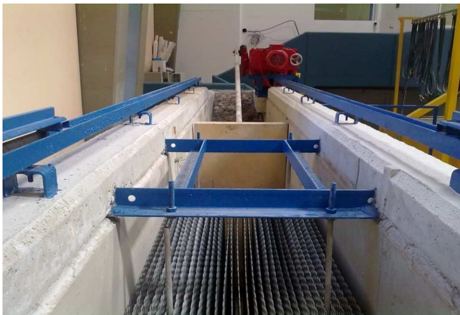
Εικόνα 5.4: Πτερύγιο κυματιστήρα και διάταξη διάτρητων πλακών ομαλοποίησης του κυματισμού.
