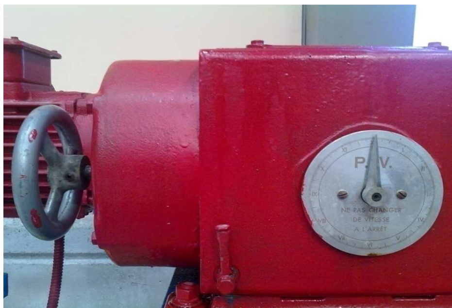
Εικόνα 5.5: Το κιβώτιο ταχυτήτων της κυματογεννήτριας το οποίο καθορίζει τις περιόδους παραγόμενου κυματισμού.
