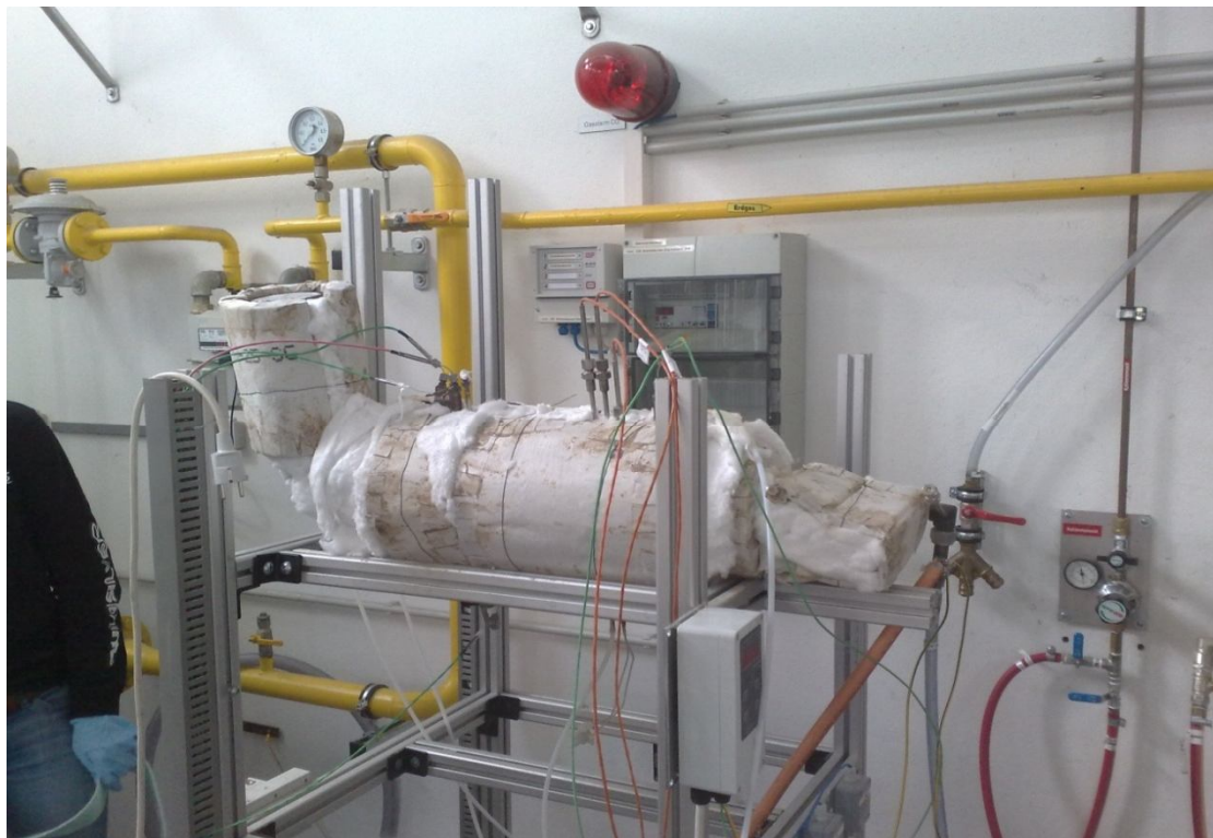
Σχ.4.9 Ο T-POX αναμορφωτής (πρώτη έκδοση) μονωμένος με τα κύρια στρώματα μόνωσης.
