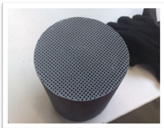
Σχ.4.5 Το wall flow filter ή soot trap από κεραμικό υλικό SiSiC.
