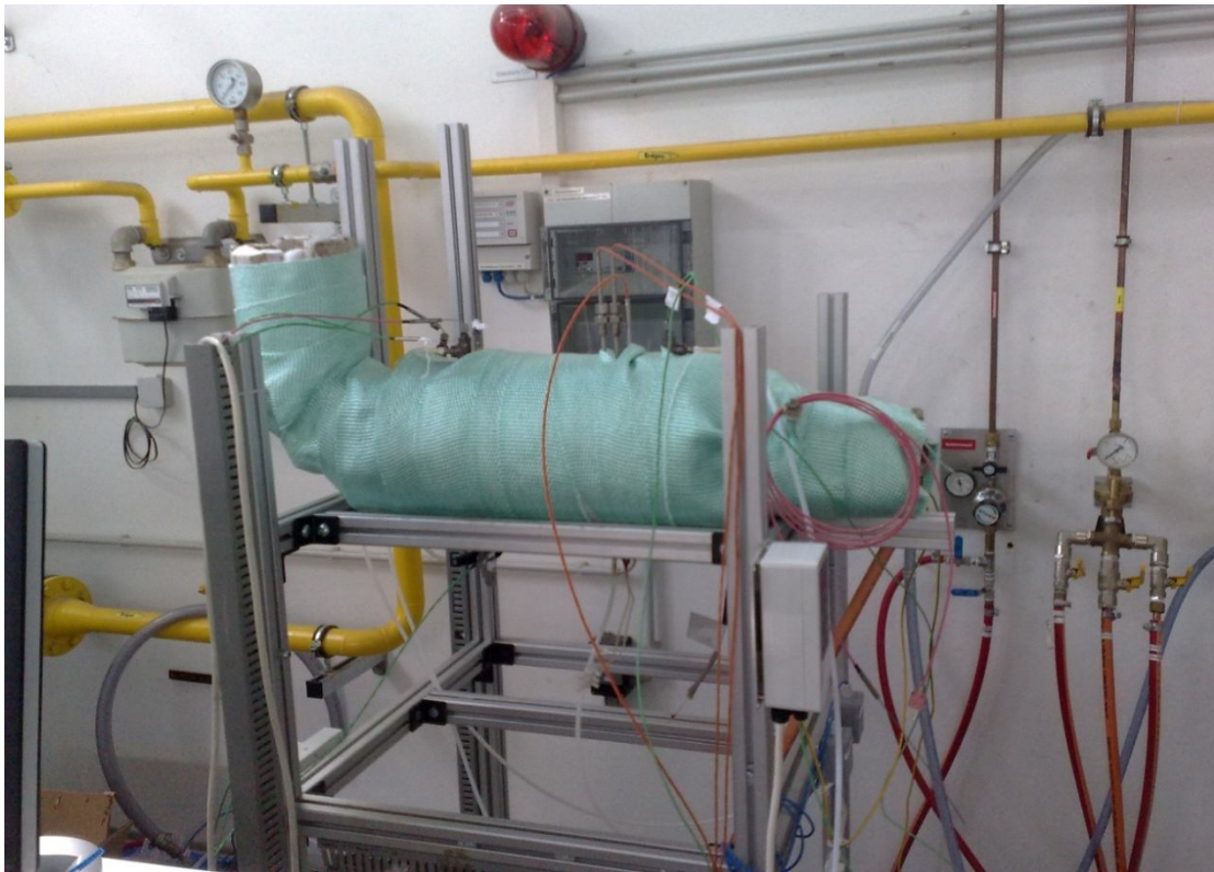
Σχ.4.10 Ο T-POX αναμορφωτής (πρώτη έκδοση) με την τελική μόνωση.
