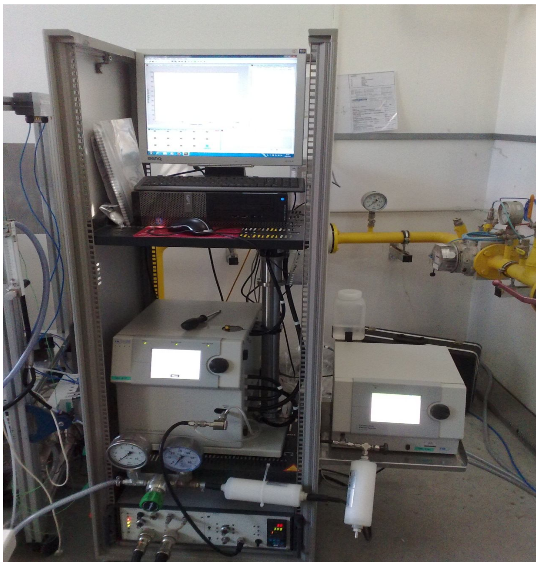
Fig.4.13 Το σύστημα του SMPS στο οποίο διενεργήθηκαν οι μετρήσεις της αιθάλης αυτής της μελέτης, στο εργαστήριο του Technical University Bergakademie of Freiberg της Γερμανίας.
