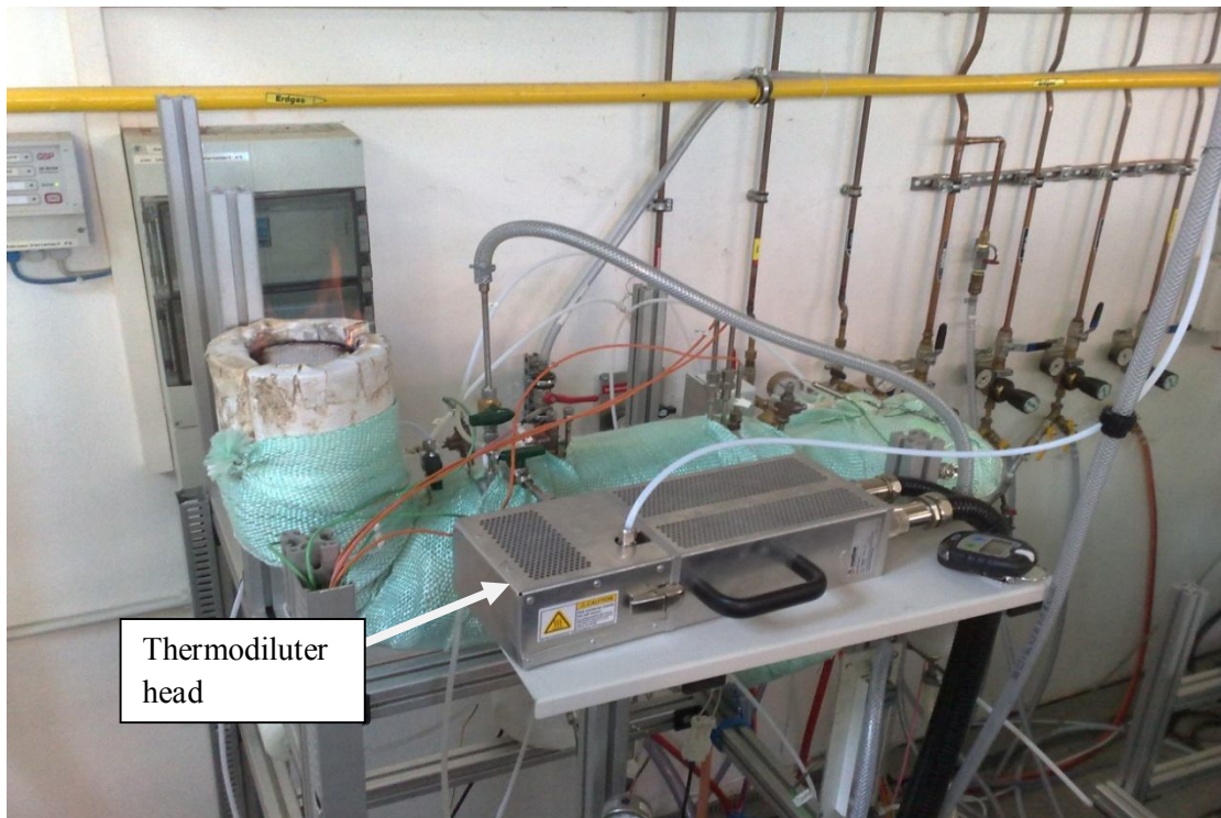
Σχ.4.11 Η τελική συνδεσμολογία (δεύτερη έκδοση) με το thermodiluter head του dilution system αναγκαίο για τις μετρήσεις της αιθάλης.
