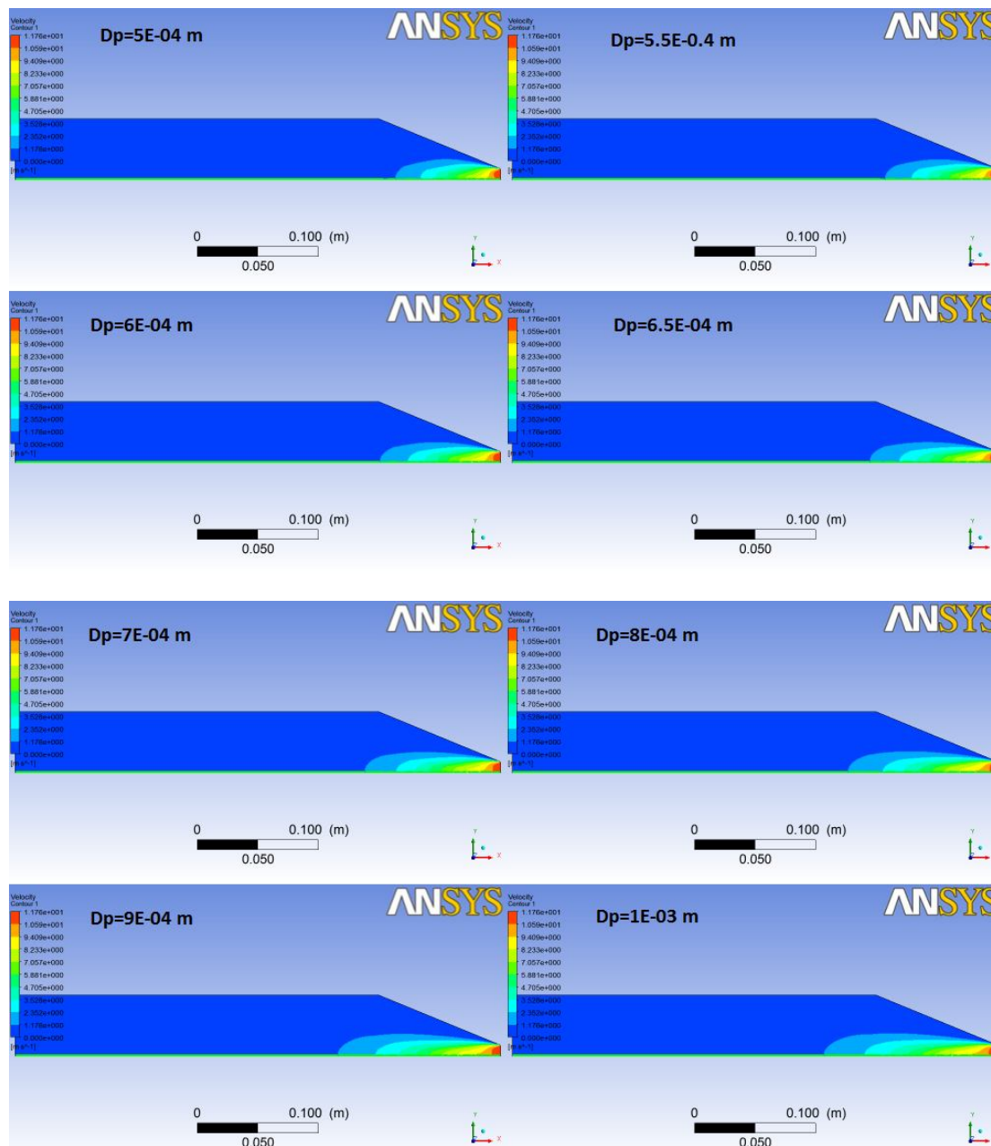
Σχ. 3.18: Κατανομή διάδοσης δέσμης αέρα σε πορώδες μέσο για διαφορετικές τιμές του medium particle diameter, ταχύτητα εισόδου 11.7 [m/s] και θερμοκρασία 293,15 [K].
