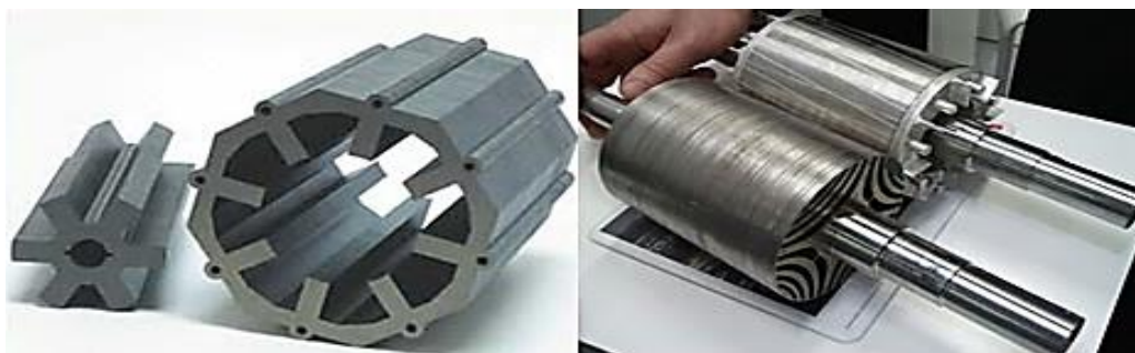
Σχήμα 2.11. Αριστερά δύο βασικά κομμάτια ενός κινητήρα μεταβλητής μαγνητικής αντίστασης (Switched Reluctance Machine) και δεξιά ο δρομέας ενός κινητήρα σύγχρονης μαγνητικής αντίστασης (Synchronous Reluctance Machine). [ 2 ]
