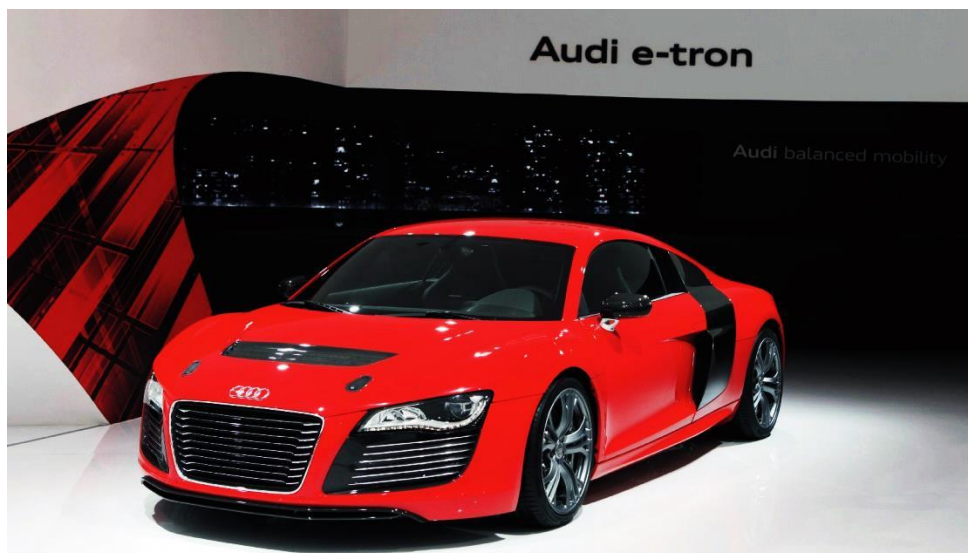
Σχήμα 2.3. Σημερινής τεχνολογίας (2011) ηλεκτρικό αυτοκίνητο από την Audi. Έχει τεσσερις ηλεκτρικούς κινητήρες (ένας σε κάθε τροχό) οι οποίοι παράγουν 4500 Nm ροπή και μπορεί να διανύσει 240 km με μια πλήρη φόρτιση. [ 30 ]
