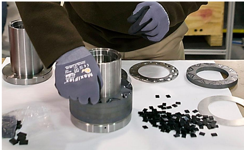
Σχήμα 2.10. Συναρμολόγηση του δρομέα. Τοποθέτηση και κόλληση ένα προς ένα των 400 κομματιών μόνιμου μαγνήτη (Chevrolet Spark 2013). [ 34 ]
