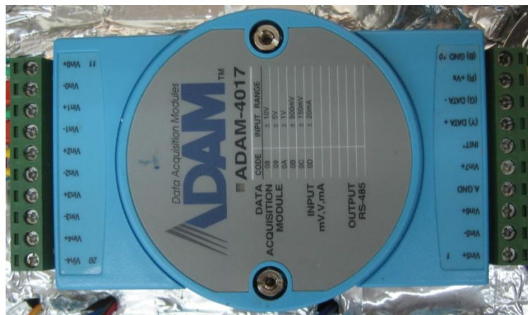
Σχήμα 4.20: Εικόνα της κάρτας ADAM-4017.
