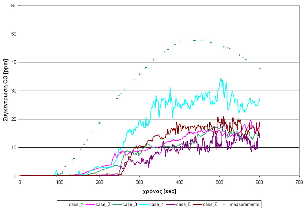
Εικόνα 32 – Διάγραμμα χρονικής εξέλιξης συγκέντρωσης CO σε ύψος 0.95m από τα δάπεδο της σήραγγας
