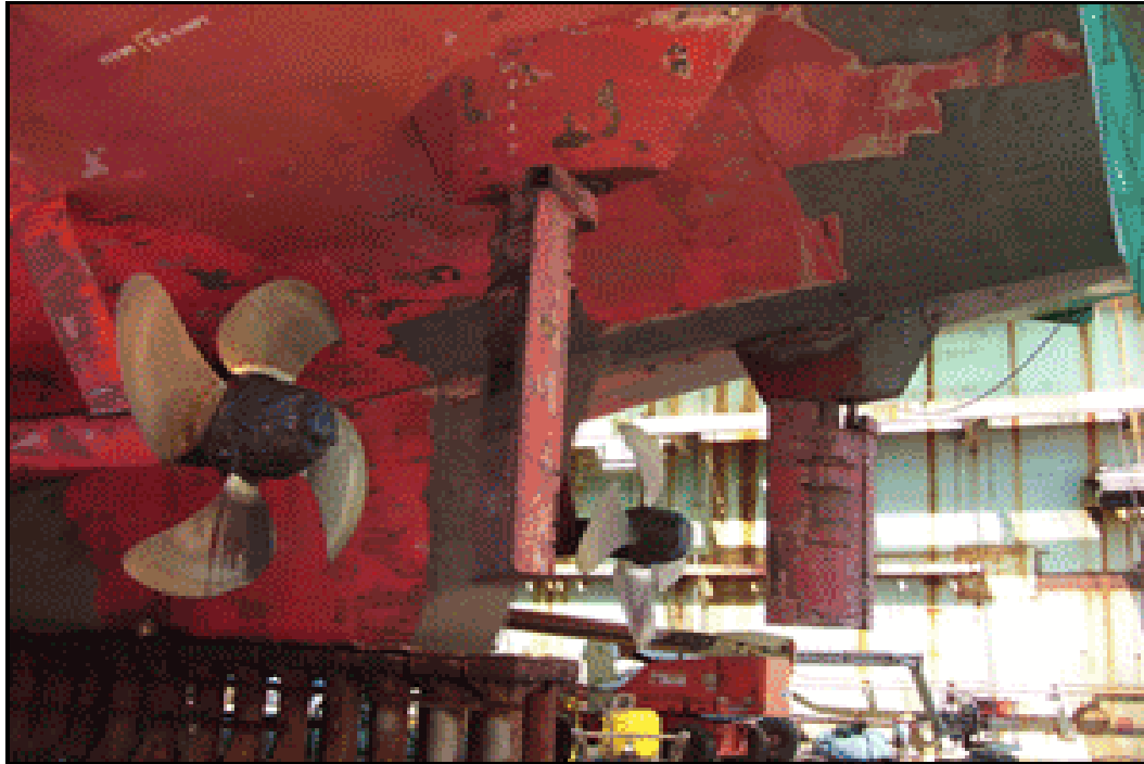
Εικόνα 1.28 Διάβρωση πηδαλίου και έλικας λόγω θαλάσσιου υδατικού περιβάλλοντος.
