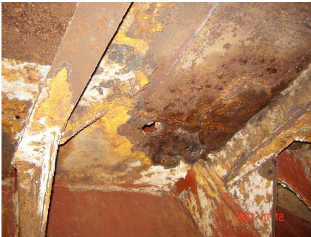
Εικόνα 7.6 Κατάσταση που δεν είναι πλέον αποδεκτή σε κύτος φορτίου.
