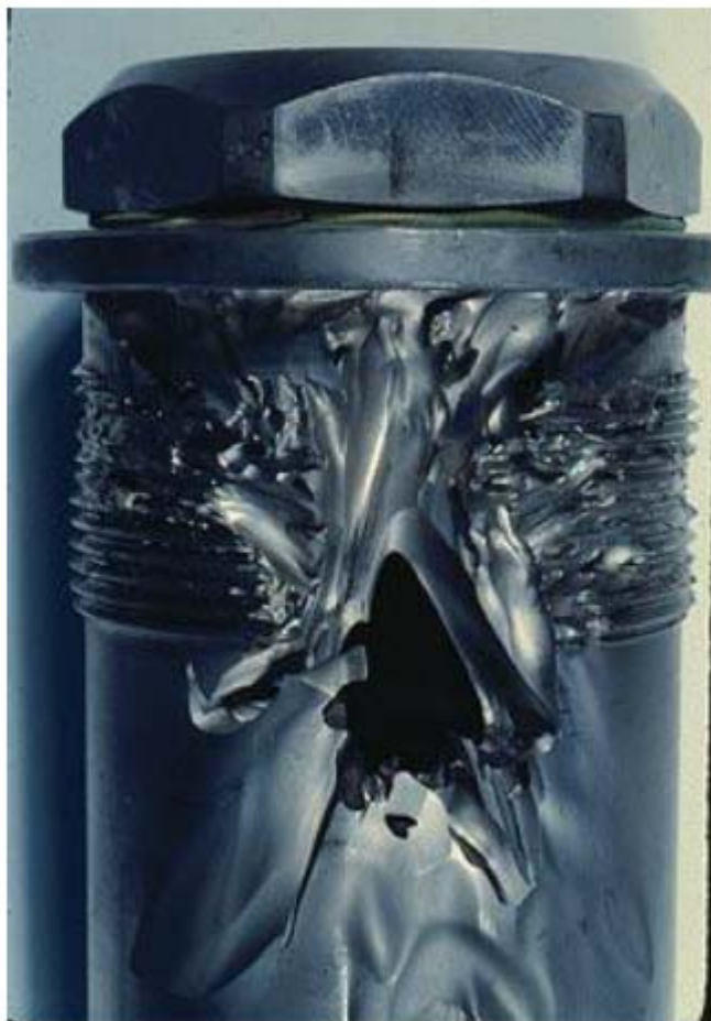
Εικόνα 1.29 Διάβρωση βίδας λόγω έντονου χημικού περιβάλλοντος [9]
