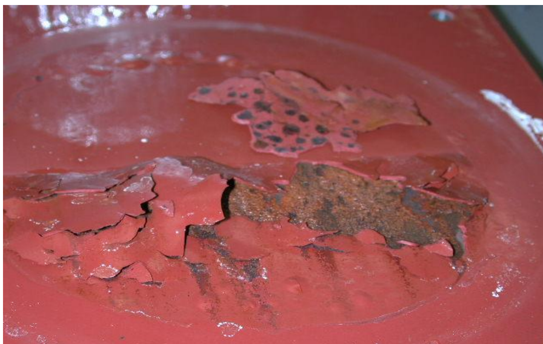
Εικόνα 6.5 Επίδραση υγρασίας στην αστοχία χρώματος http://www.raeengineering.ca/cms/61/coatings_and_linings/
