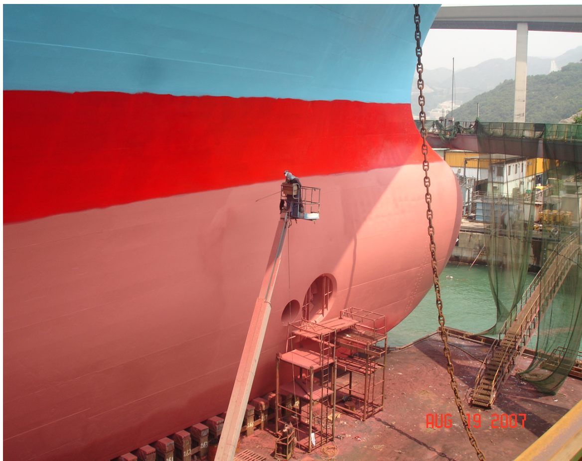
Εικόνα 7.10 Διαδικασία βαφής με υφαλοχρώματα Costamare Shipping Company Archives
