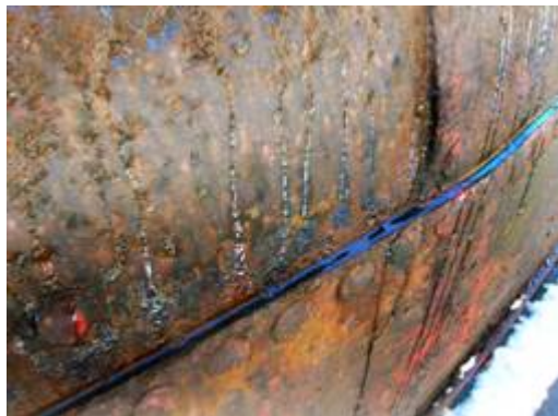
Εικόνα 1.10 Ομοιόμορφη διάβρωση σε γάστρα πλοίου.
