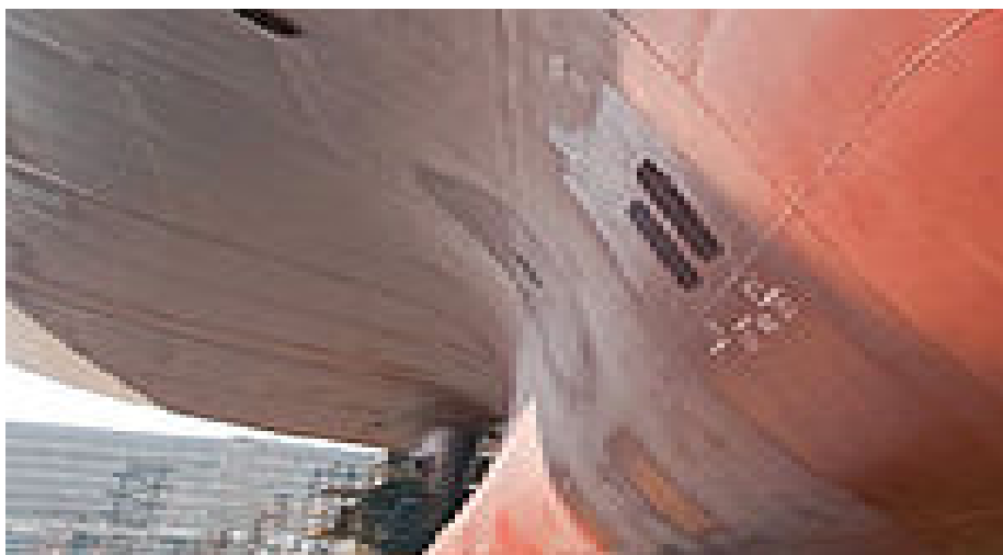
Εικόνα 3.4 Εποξεικό Αστάρι εξωτερικά σε έλασμα πλοίου.
