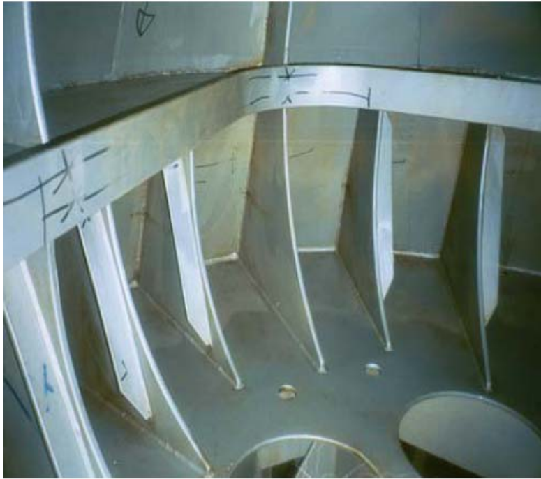
Εικόνα 7.5 Επικαλυμμένη δεξαμενή έρματος πλώρας μετά από 5 χρόνια υπηρεσίας. Το επίστρωμα δεν παρουσίασε καμία ατέλεια μετά από 5 χρόνια, το οποίο δείχνει ότι είναι δυνατή η μακροχρόνια απόδοση των επιστρωμάτων για τα διαμερίσματα αυτά (πρωραία).
