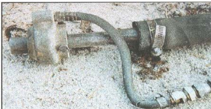
Εικόνα 4.3 Ακροφύσιο για υδροβολή με κουρτίνα
