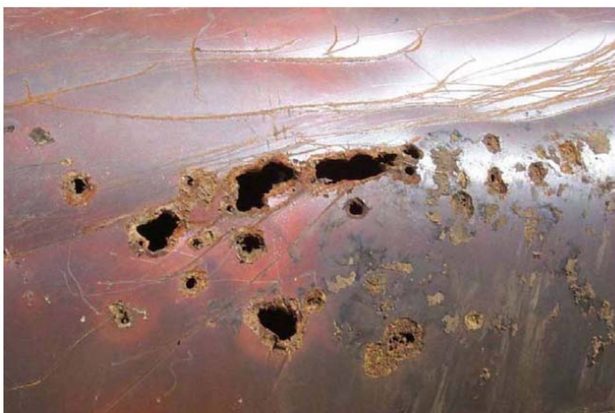
Εικόνα 1.19 Γαλβανική Διάβρωση σε έλασμα πλοίου.
