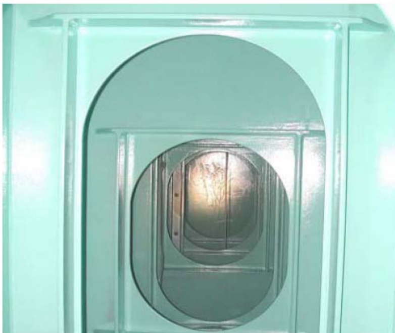
Εικόνα 7.4 Πρόσφατα επικαλυμμένη πλευρική δεξαμενή έρματος, προτού χρησιμοποιηθεί. http://www.lr.org/Search.aspx?q=fouling&p=~sectors/marine
