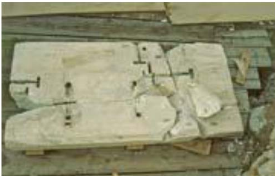
Εικόνα 1.26 Μηχανική διάβρωση μαρμάρου λόγω διαφορετικής θερμικής διαστολής των υλικών μετάλλου-μαρμάρου
