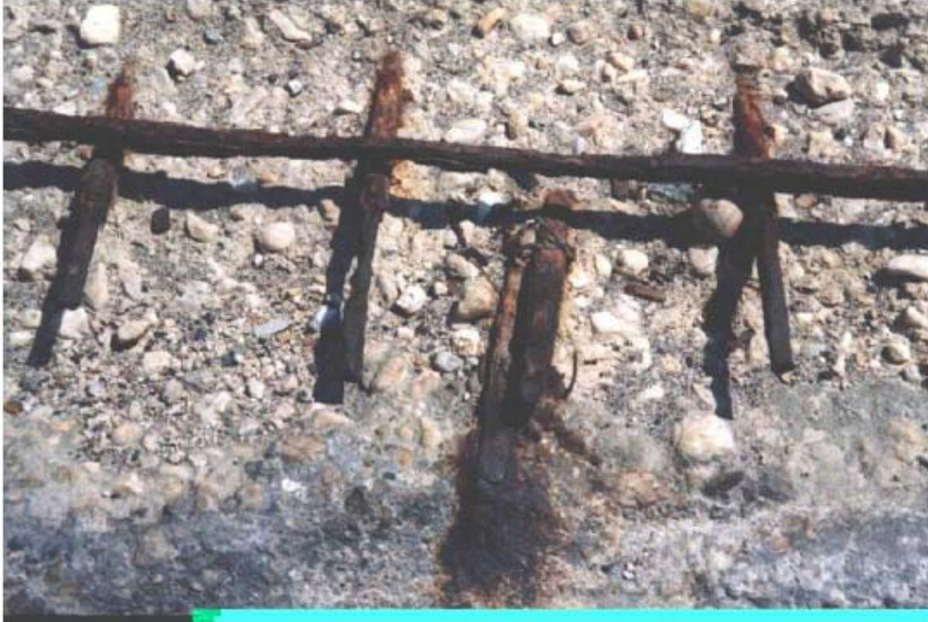
Εικόνα 1.27 Διάβρωση μεταλλικών αντικειμένων στο έδαφος http://www.bushman.cc/corrosion_photos.html
