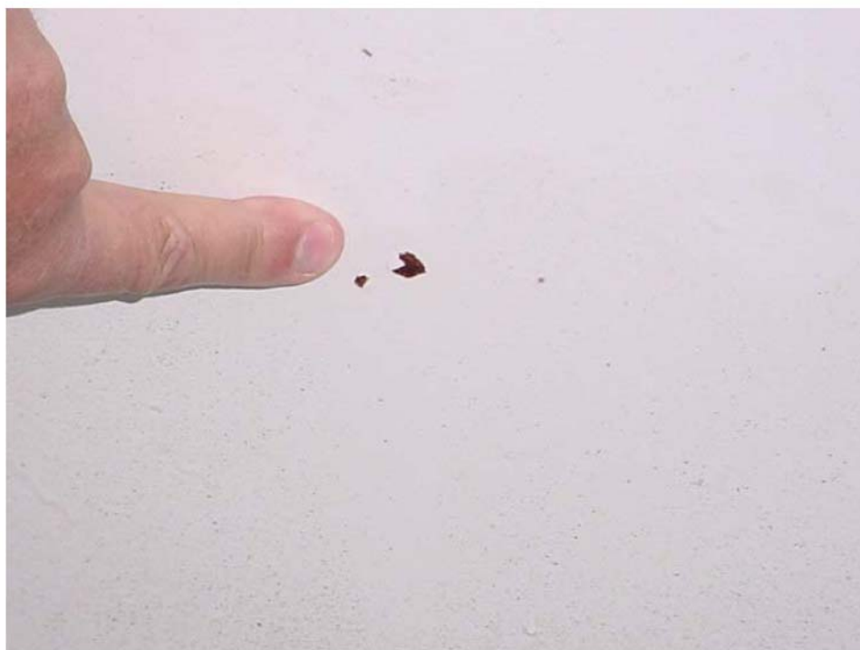
Εικόνα 6.1 Αποφλοίωση χρώματος από αγωγό http://www.stoprust.com/3coatingfailures.htm
