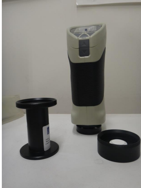
Εικόνα 6.28: Χρωματόμετρο και εξαρτήματα καλιμπραρίσματος του οργάνου, εξοπλισμός του Εργαστηρίου Ναυπηγικής Τεχνολογίας.
