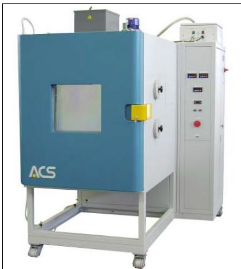
Εικόνα 6.5: Ημιβιομηχανικός Κλιματικός θάλαμος τύπου ACS Global Test System 600, εξοπλισμός του Τομέα Επιστήμης και Τεχνικής των Υλικών.
