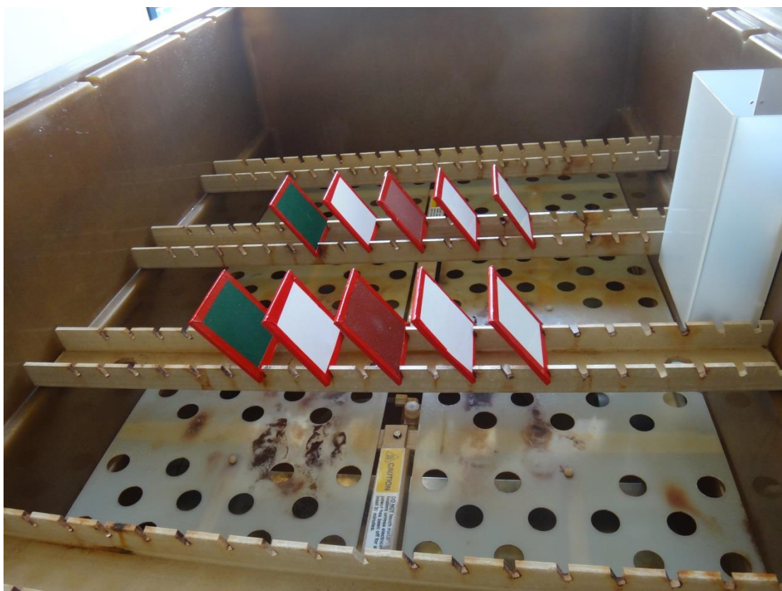
Εικόνα 6.4: Δοκίμια στο θάλαμο αλατονέφωσης, πριν την έναρξη των πειραμάτων, 1 δοκίμιο από κάθε σύστημα μετά από ‘sun test’ και 1 δοκίμιο από κάθε σύστημα μετά από 900 ώρες ‘solar simulation’. Τα δοκίμια είναι τοποθετημένα από αριστερά προς τα δεξιά ως εξής: σύστημα 2 - χλωριωμένο αλκυδικό (πράσινο), σύστημα 1 - αλκυδικό (άσπρο), σύστημα 4 – antifouling (κόκκινο), σύστημα 3 – εποξική ρητίνη ως αστάρι και φινίρισμα πολυουρεθάνης (άσπρο) και σύστημα 5 – εποξική ρητίνη ως αστάρι και φινίρισμα ασπαρτικής πολυουρεθάνης (άσπρο).
