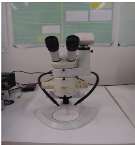
Εικόνα 6.32: Οπτικό στερεοσκόπιο της εταιρίας LEICA MZ6, εξοπλισμός του Εργαστηρίου Ναυπηγικής Τεχνολογίας.
