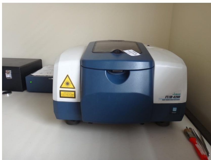
Εικόνα 8.3: Φασματόμετρο υπέρυθρου με μετασχηματισμό Fourier της εταιρίας Jasco, μοντέλο 4200.
