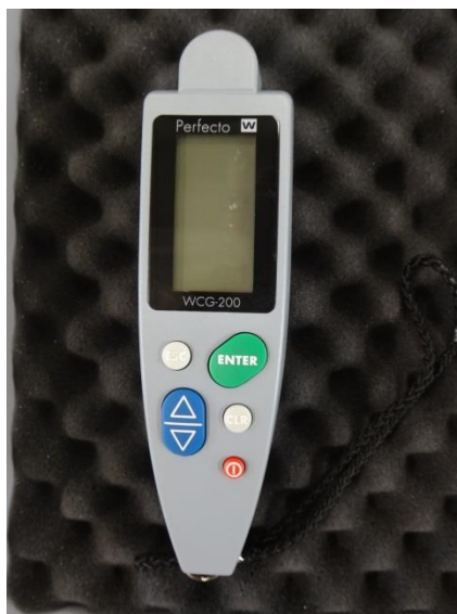
Εικόνα 6.30: Όργανο μέτρησης πάχους οργανικού επιστρώματος, εξοπλισμός του Εργαστηρίου Ναυπηγικής Τεχνολογίας.
