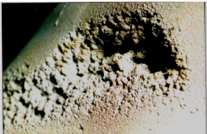
Εικόνα 1.6: Σπηλαιώδης μηχανική διάβρωση σε έλικα [Καρύδης 2002].
