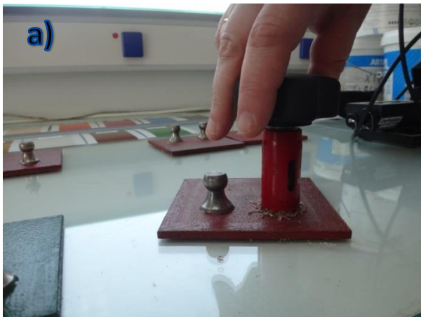
Εικόνα 8.9: Απομάκρυνση περίσσειας κόλλας με μεταλλική ξύστρα.
