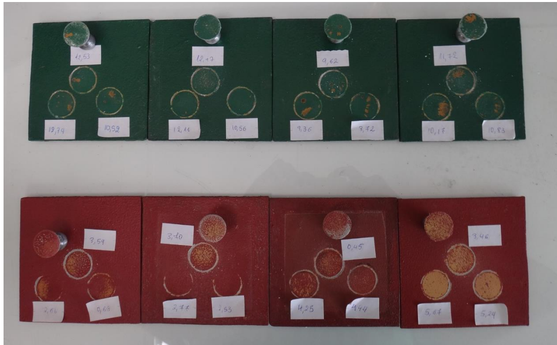
Εικόνα 8.11: Δοκίμια συστήματος 2&4 μετά από τη μηχανική δοκιμή πρόσφυσης, pull off test.
