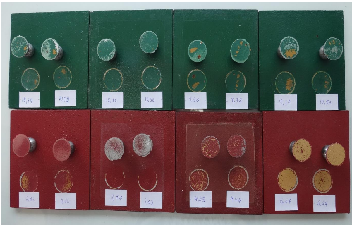
Εικόνα 8.10: Δοκίμια συστήματος 2&4 μετά από τη μηχανική δοκιμή πρόσφυσης, pull off test.
