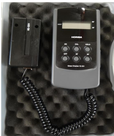
Εικόνα 6.29: Όργανο μέτρησης στιλπνότητας, εξοπλισμός του Εργαστηρίου Ναυπηγικής Τεχνολογίας.
